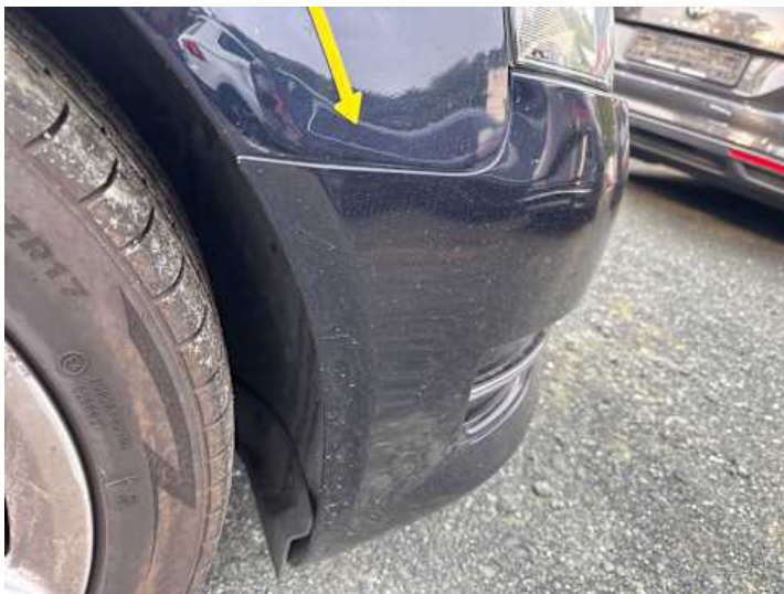
Stoßstange vorne (Unsachgemäß instand gesetzt)
