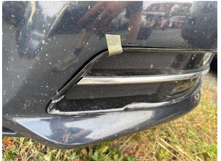
Stoßstange vorne (Unsachgemäß instand gesetzt)
