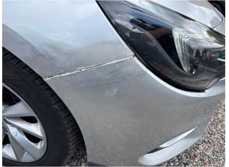
Stoßstange vorne (Lackschaden, Spaltmaße ungenau, Unsachgemäß instand gesetzt)
