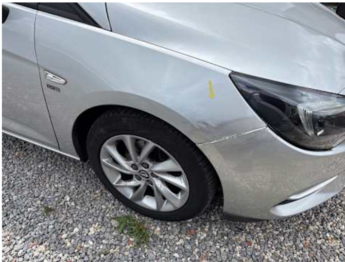
Kotflügel vorne rechts (Kratzer, Lackschaden, Spaltmaße ungenau, Unsachgemäß instand gesetzt)
