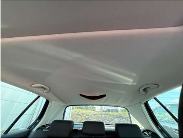
Innenraum (Anderer Schaden): Dachhimmel hängt
