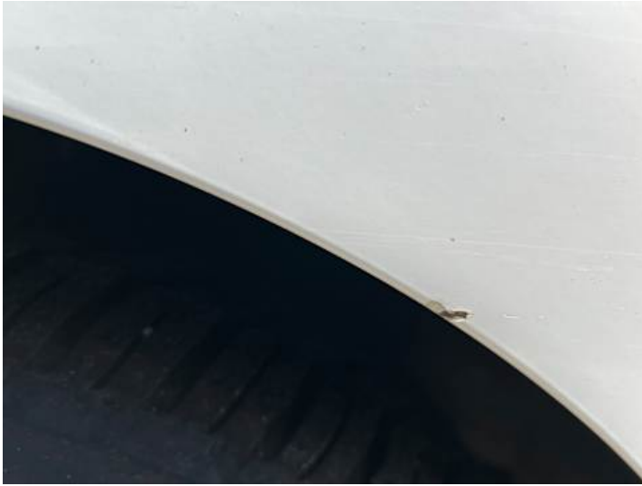
Seitenteil hinten rechts (Lackschaden)
