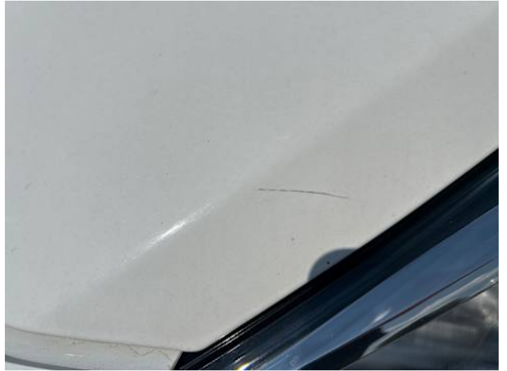
Motorhaube (Kratzer, Lackschaden)
