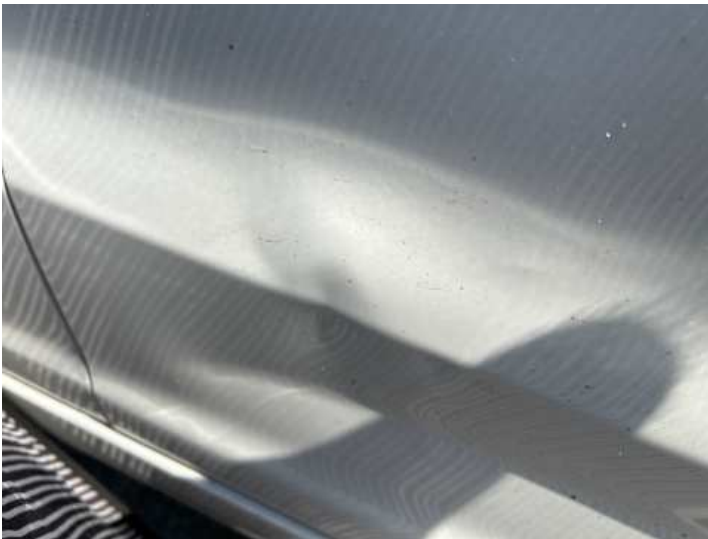
Beifahrertür (Lackschaden, Verformung)
