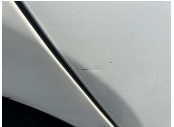
Türe hinten rechts (Lackschaden)
