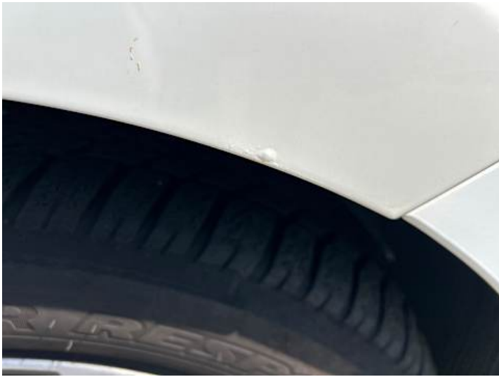
Kotflügel vorne rechts (Rost)
