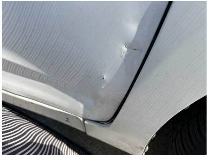
Beifahrertür (Lackschaden, Verformung)
