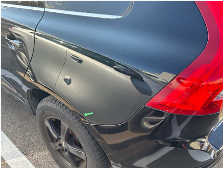
Seitenteil hinten links (Rost)
