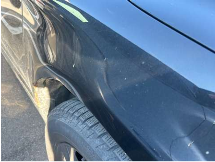
Kotflügel vorne rechts (Verformung, Rost)
