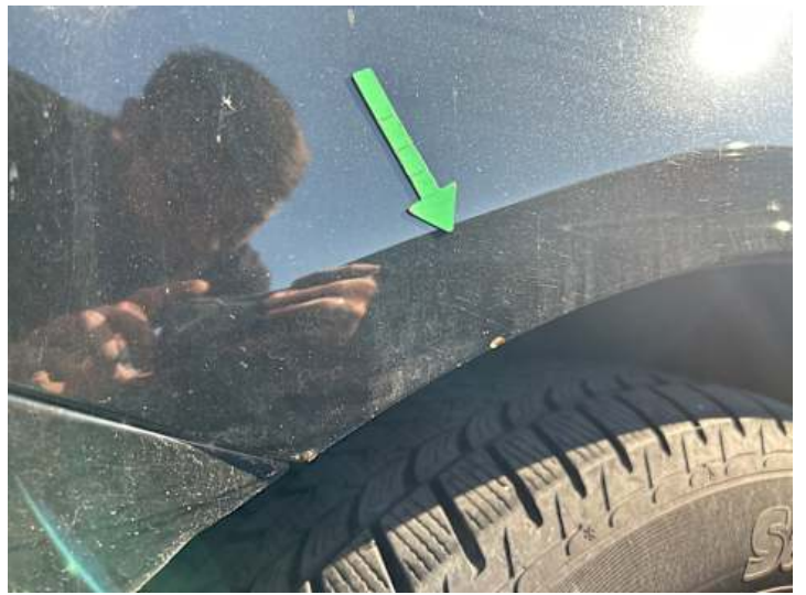
Seitenteil hinten rechts (Rost)
