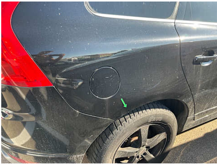
Seitenteil hinten rechts (Rost)
