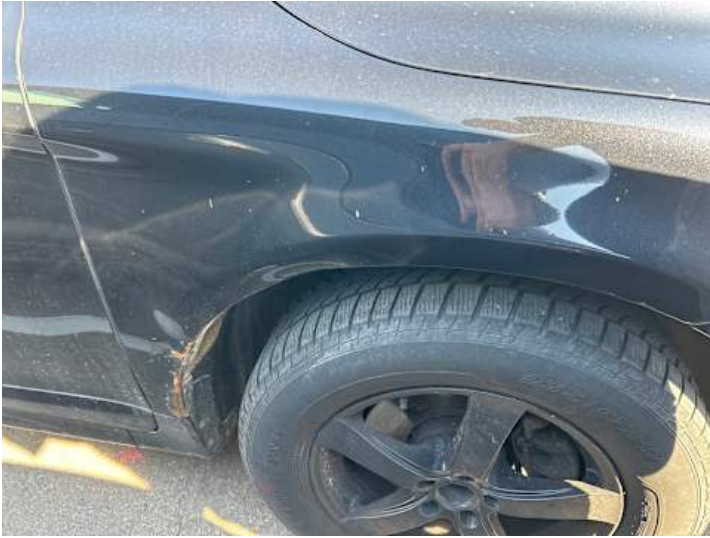
Kotflügel vorne rechts (Verformung, Rost)
