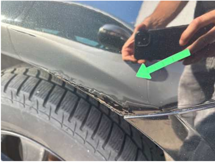
Seitenteil hinten links (Rost)
