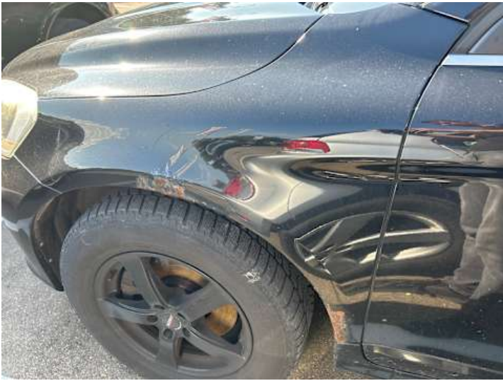
Kotflügel vorne links (Rost)
