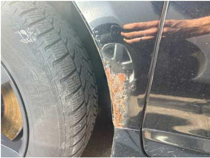
Kotflügel vorne links (Rost)
