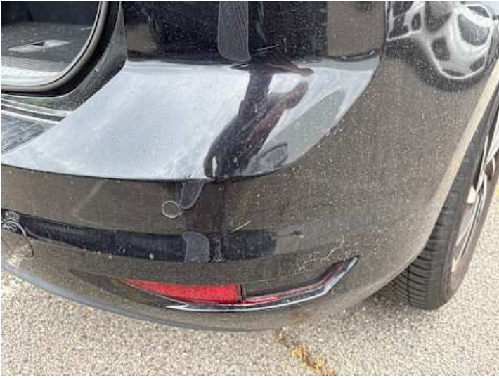
Stoßstange hinten (Kratzer)
