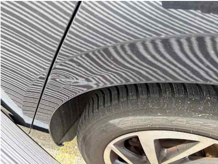
Seitenteil hinten links (Verformung, Kratzer)
