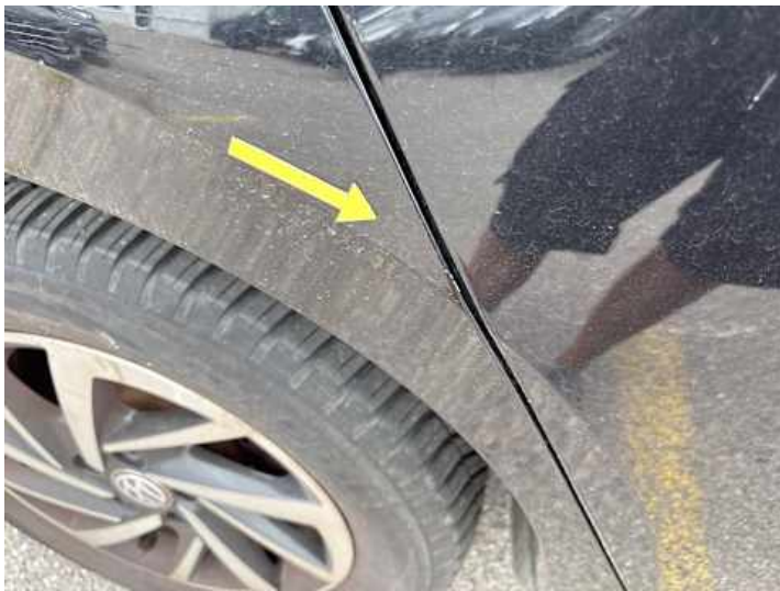
Seitenteil hinten rechts (Kratzer)
