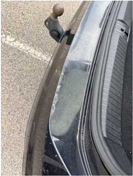
Stoßstange hinten (Kratzer)
