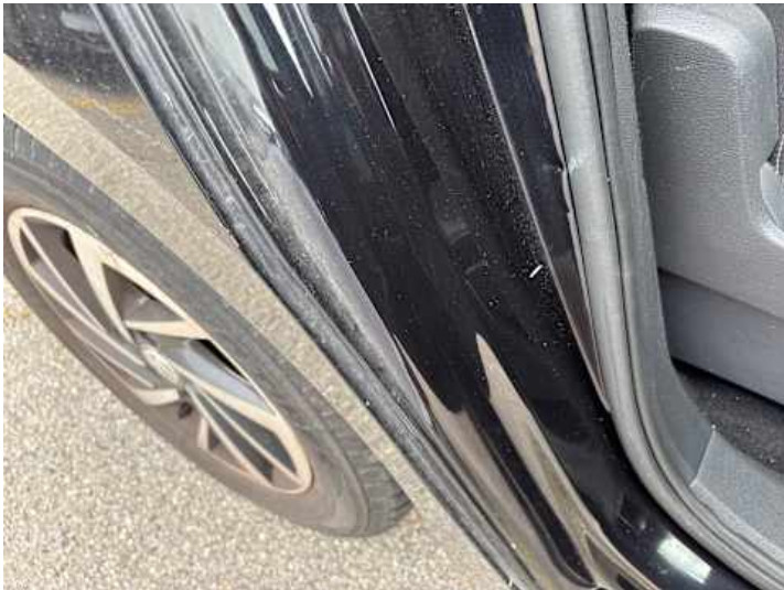
Seitenteil hinten rechts (Kratzer)
