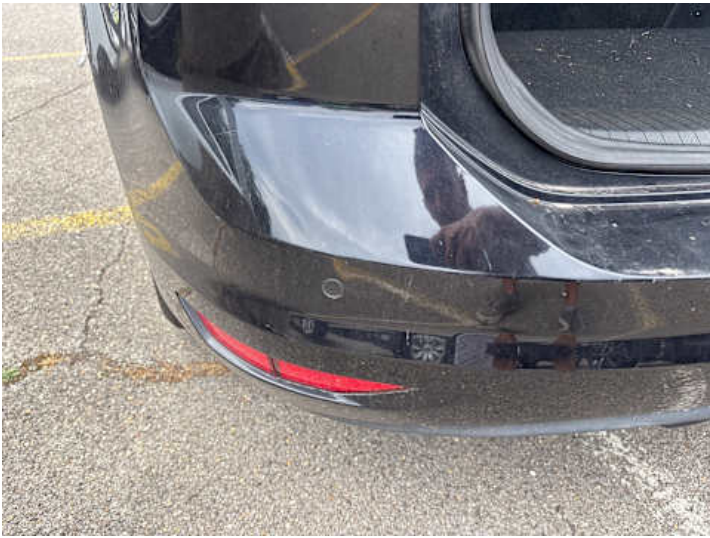
Stoßstange hinten (Kratzer)
