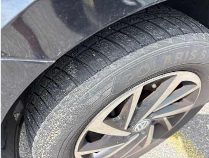
Rad (Ungleichmäßig abgefahren)
