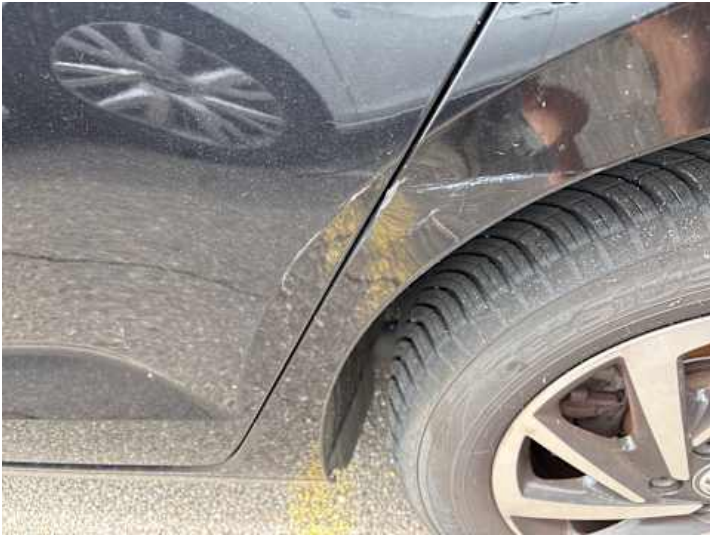
Türe hinten links (Kratzer, Verformung)
