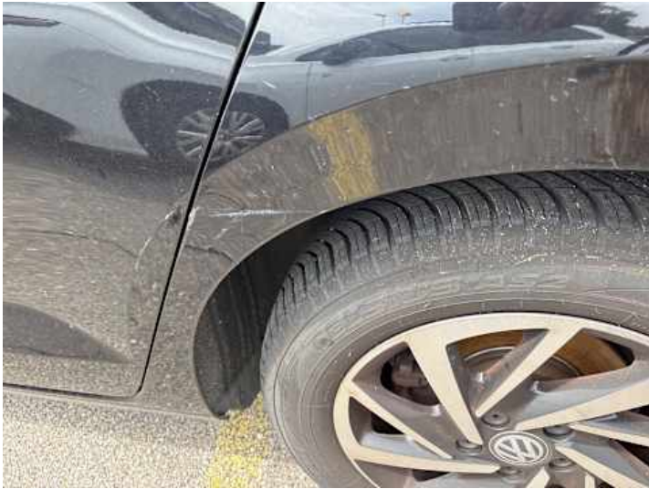
Seitenteil hinten links (Verformung, Kratzer)
