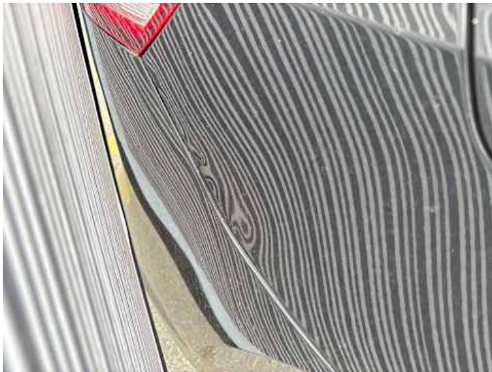
Seitenteil hinten rechts (Verformung)
