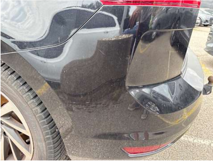
Stoßstange hinten (Kratzer)
