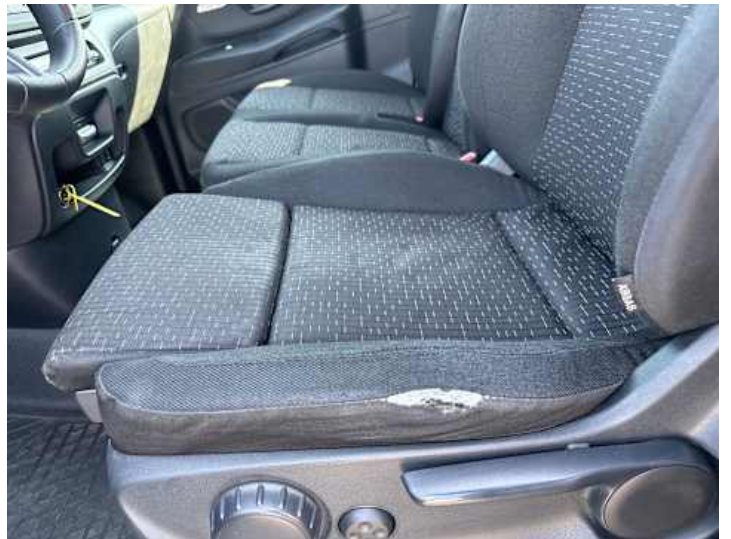
Innenraum (Verschleiß, Riss/Bruch)
