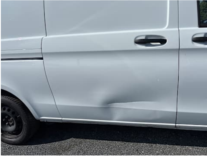
Türe hinten rechts (Lackschaden, Delle, Verformung)
