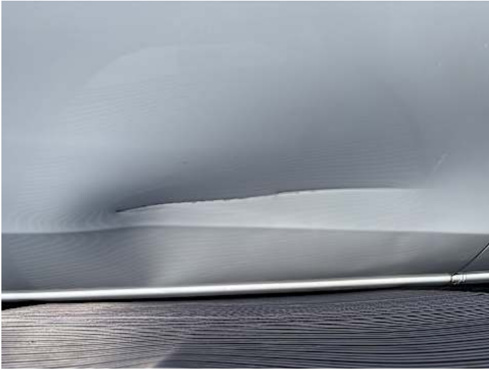
Türe hinten rechts (Lackschaden, Delle, Verformung)
