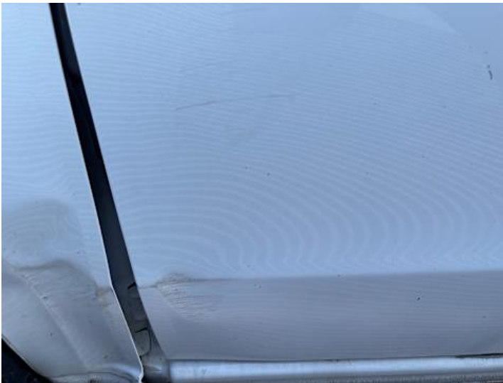
Fahrtür (Delle, Verformung, Lackschaden)
