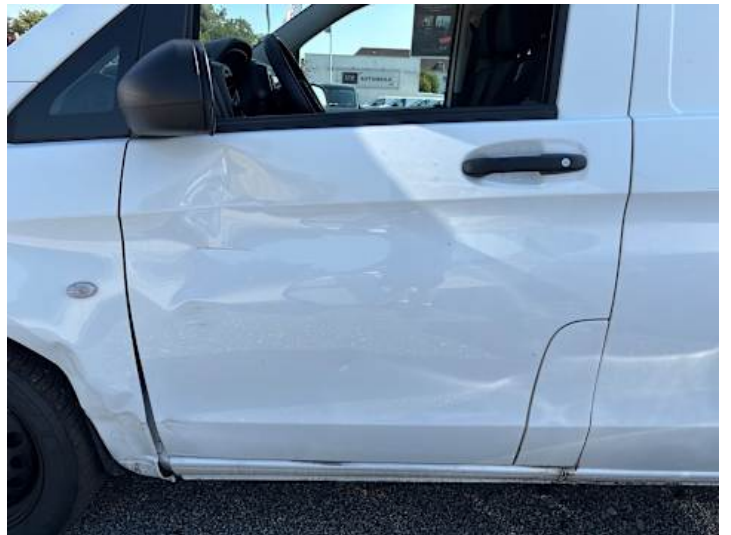
Fahrtür (Delle, Verformung, Lackschaden)
