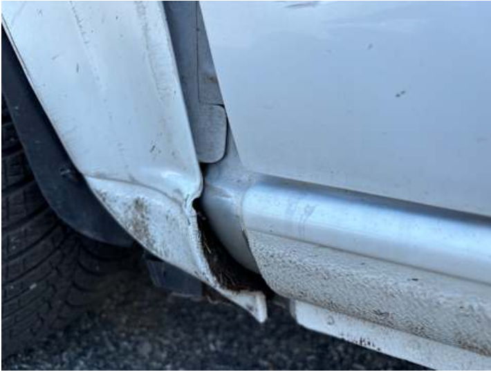
Schweller links (Verformung, Kratzer)
