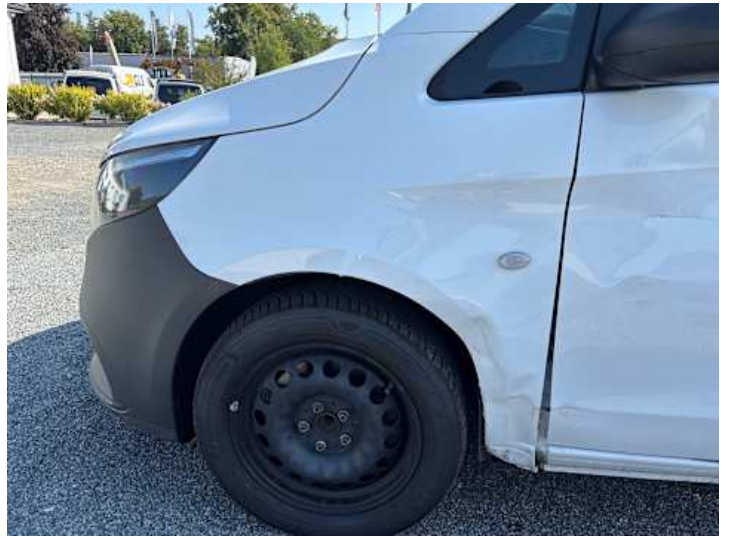
Kotflügel vorne links (Verformung, Riss/Bruch, Spaltmaße ungenau, Lackschaden)
