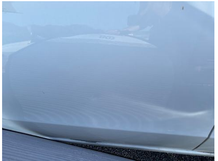
Fahrtür (Delle, Verformung, Lackschaden)
