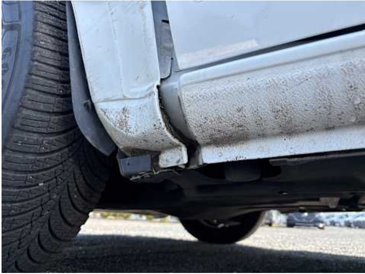
Schweller links (Verformung, Kratzer)
