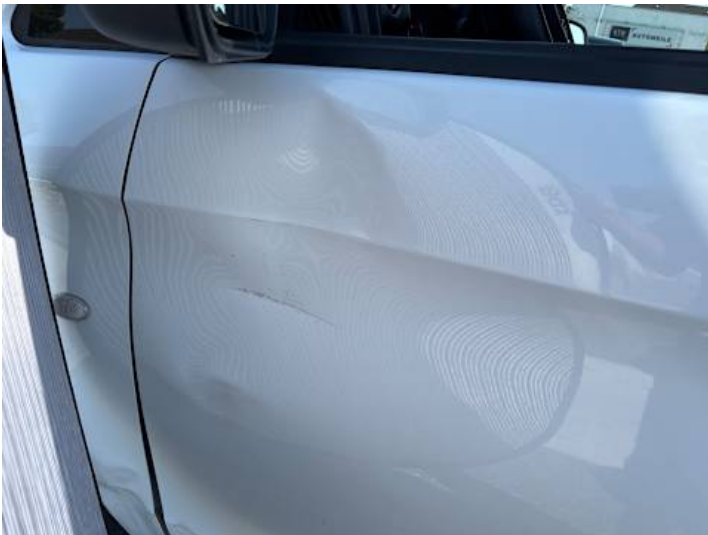
Fahrtür (Delle, Verformung, Lackschaden)
