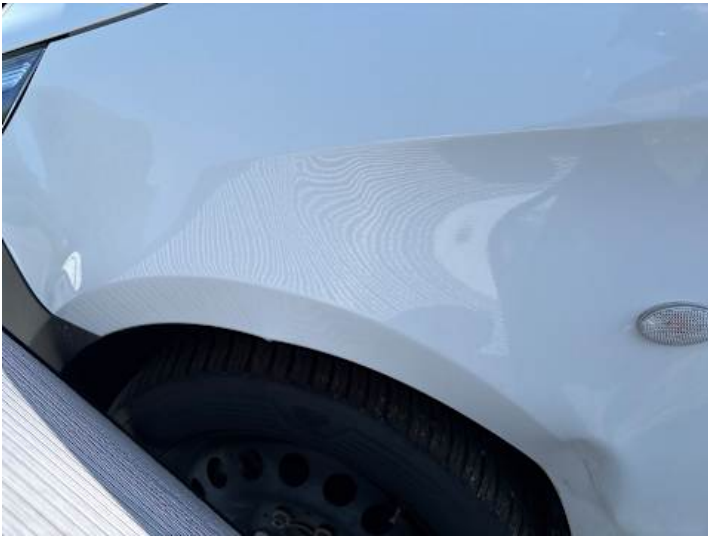
Kotflügel vorne links (Verformung, Riss/Bruch, Spaltmaße ungenau, Lackschaden)
