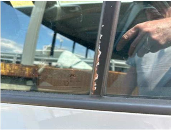
Türe hinten links (Rost)
