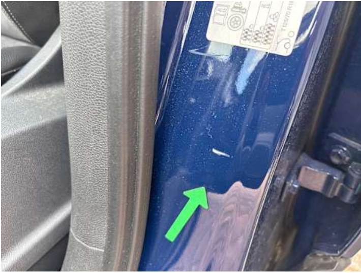
Schweller links (Kratzer)
