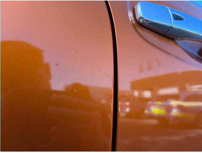
Türe hinten rechts (Kratzer, Lackschaden)
