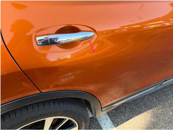
Türe hinten rechts (Kratzer, Lackschaden)
