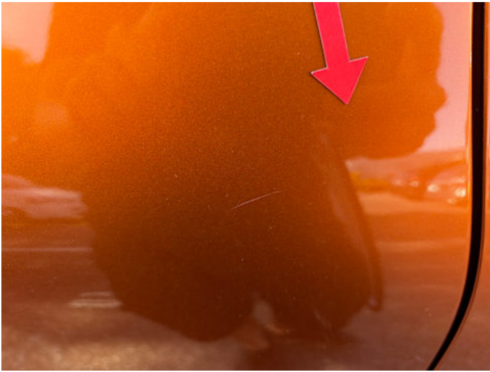
Türe hinten rechts (Kratzer, Lackschaden)
