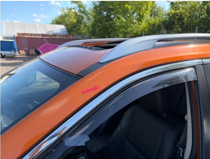
Dach (Kratzer, Lackschaden, Delle)
