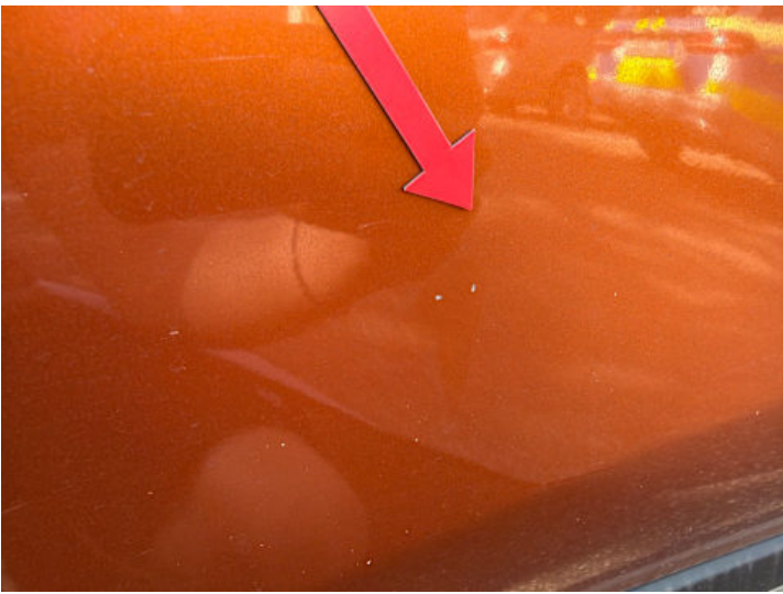
Türe hinten rechts (Kratzer, Lackschaden)
