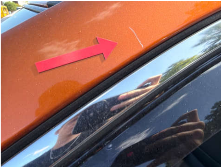
Dach (Kratzer, Lackschaden, Delle)
