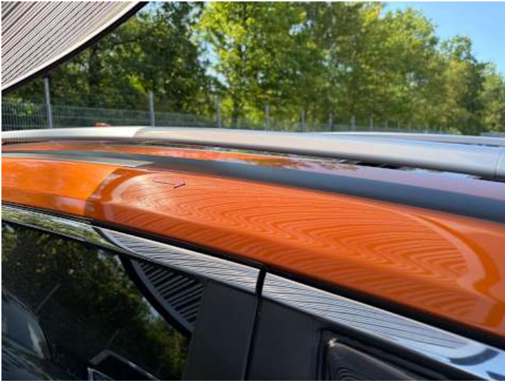
Dach (Kratzer, Lackschaden, Delle)
