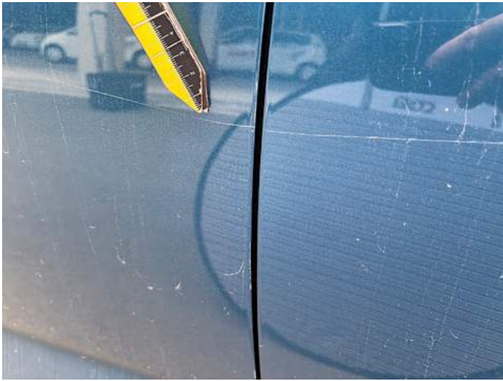
Fahrtür (Lackschaden, Kratzer)
