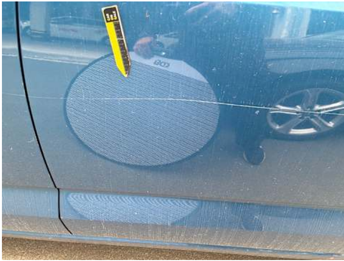
Türe hinten links (Lackschaden, Kratzer)
