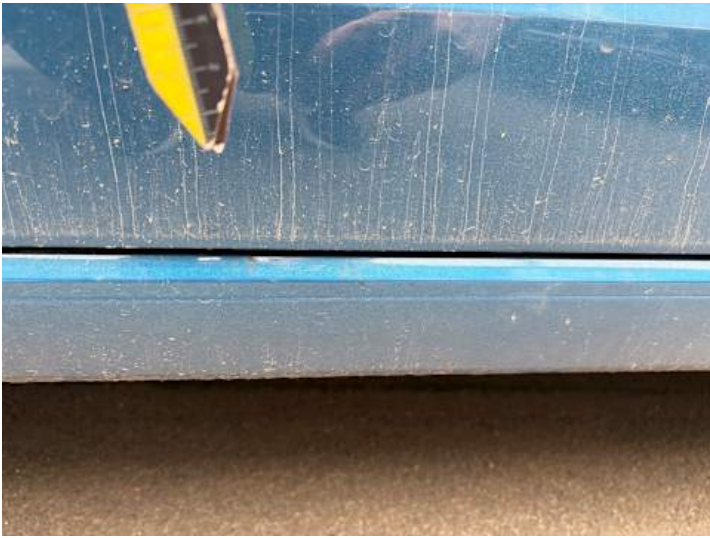
Schweller links (Lackschaden, Kratzer)
