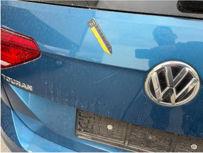
Heckklappe (Lackschaden, Kratzer)
