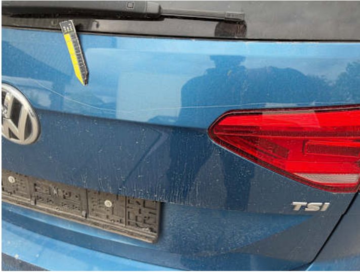
Heckklappe (Lackschaden, Kratzer)
