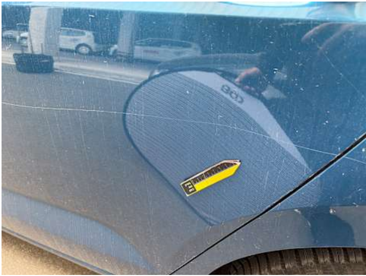
Türe hinten links (Lackschaden, Kratzer)
