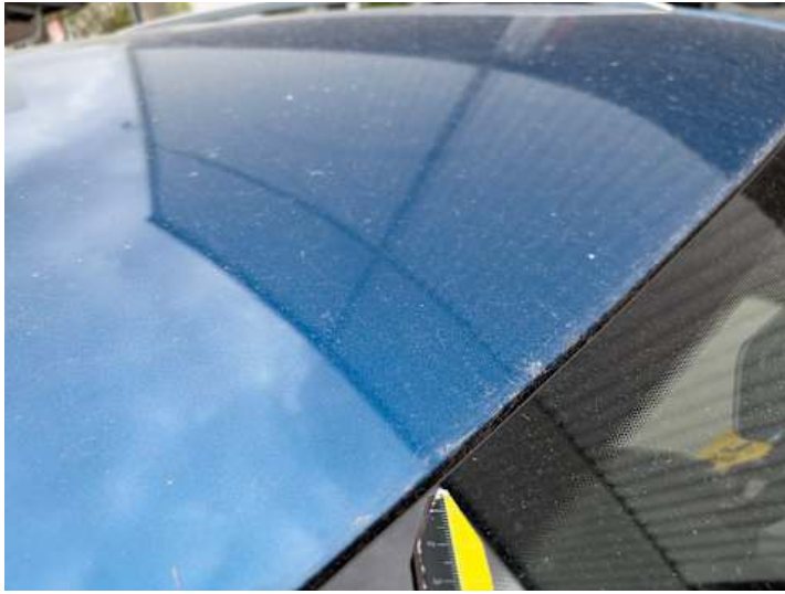
Dach (Lackschaden, Steinschlag)
