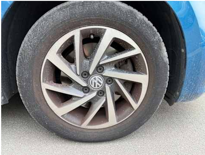
Rad (Kerben, Kratzer, Rost)
