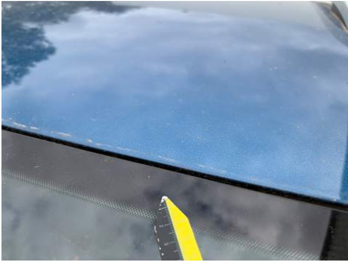
Dach (Lackschaden, Steinschlag)
