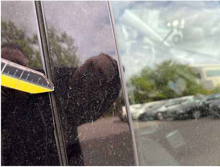
Beifahrtür (Lackschaden, Kratzer)
