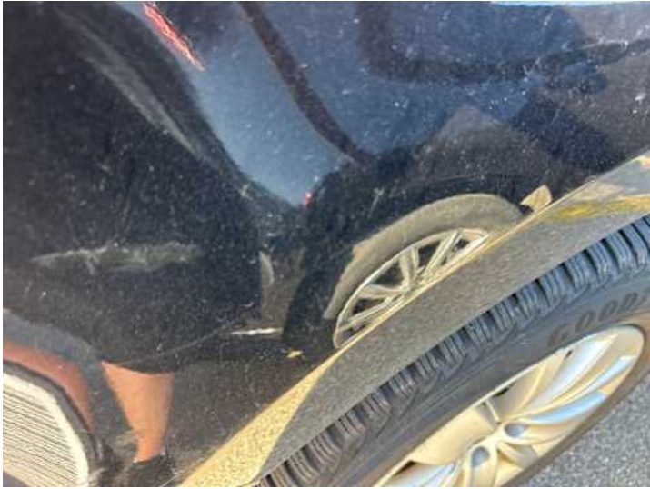
Seitenteil hinten rechts (Lackschaden)
