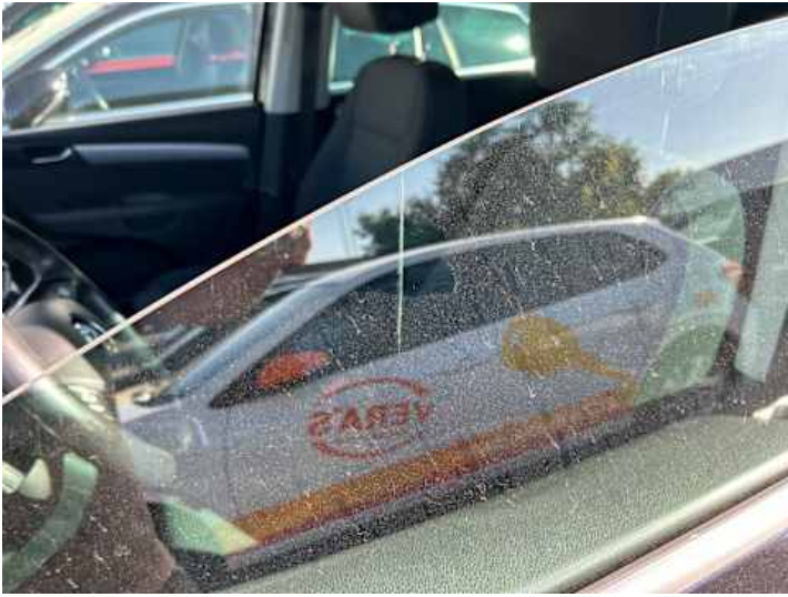
Fahrtür (Anderer Schaden): Scheibe verkratzt
