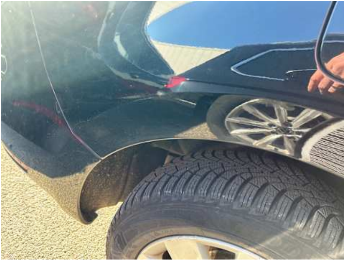
Seitenteil hinten rechts (Lackschaden)
