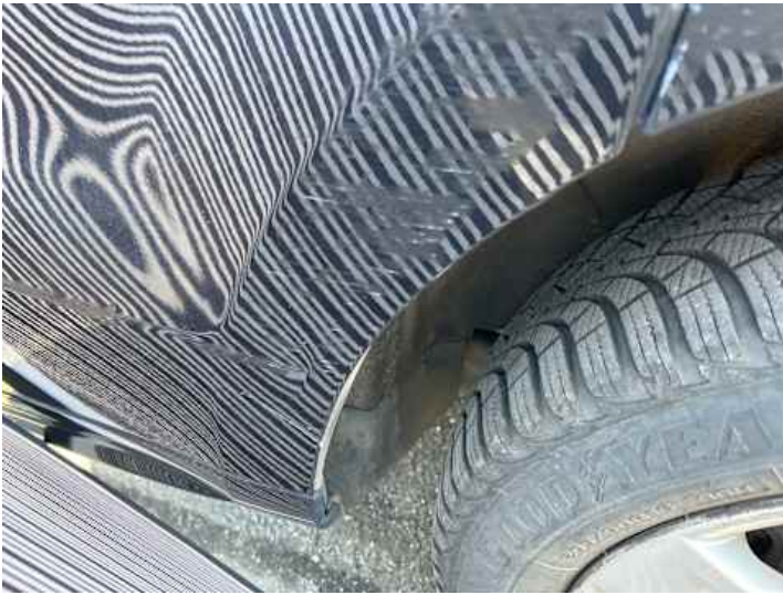
Türe hinten links (Kratzer, Verformung)
