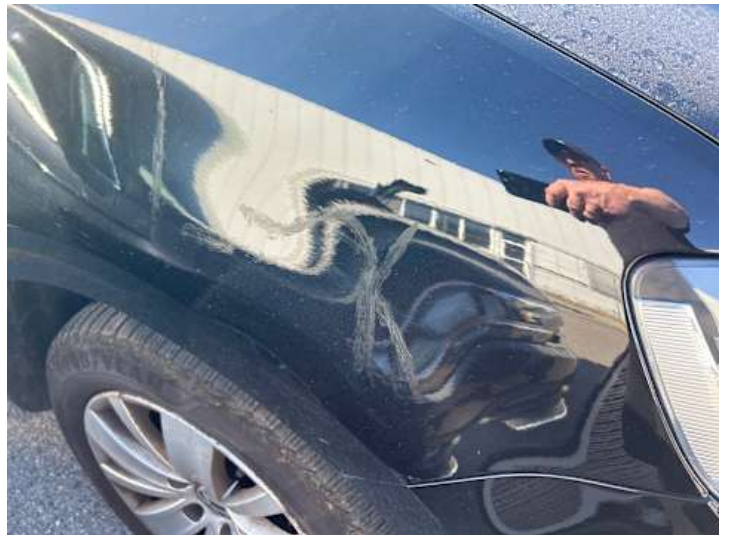
Kotflügel vorne rechts (Lackschaden)
