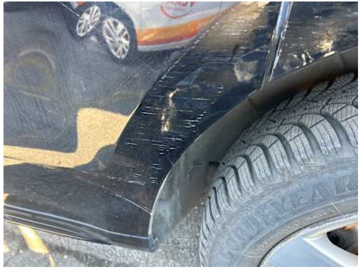
Türe hinten links (Kratzer, Verformung)
