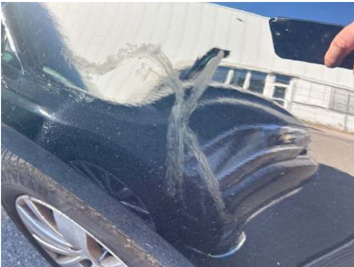
Kotflügel vorne rechts (Lackschaden)
