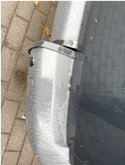
Stoßstange hinten (Riss/Bruch)
