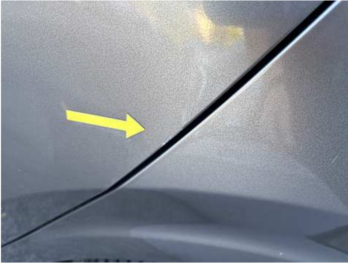
Türe hinten links (Lackschaden)
