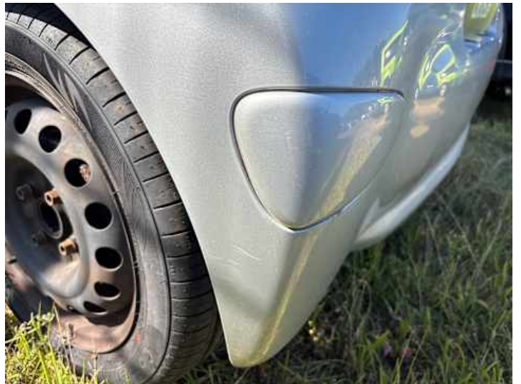
Stoßstange hinten (Kratzer, Lackschaden, Verformung)
