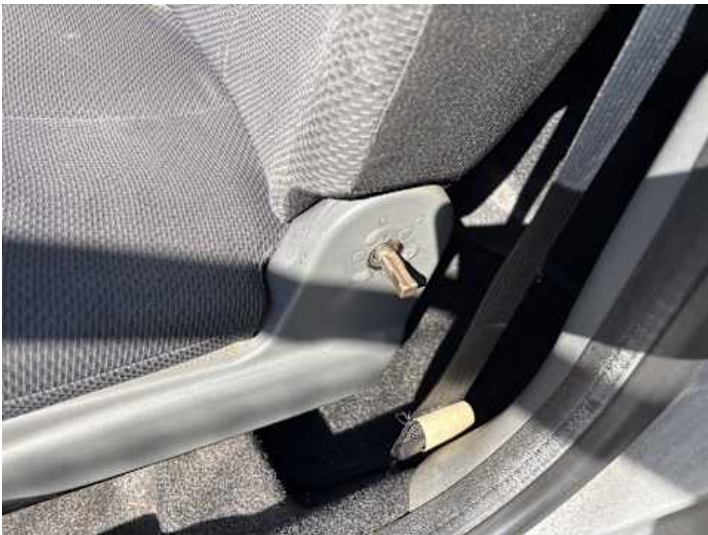
Innenraum (Anderer Schaden): Hebel links fehlt,
