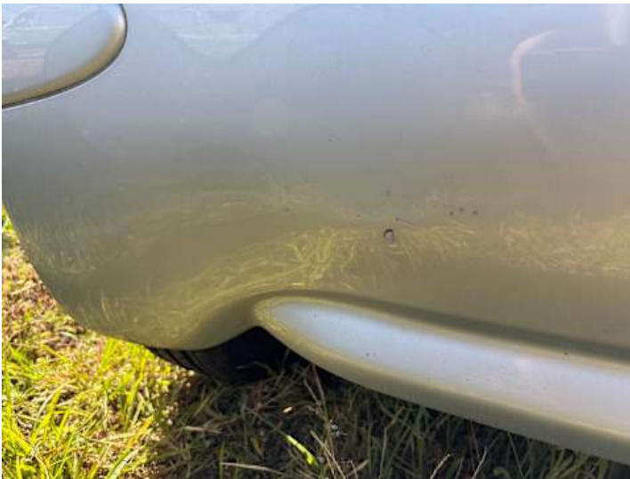
Stoßstange hinten (Kratzer, Lackschaden, Verformung)
