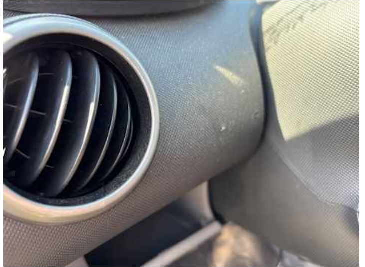
Innenraum (Anderer Schaden): Bohrlöcher im Armaturenbrett,
