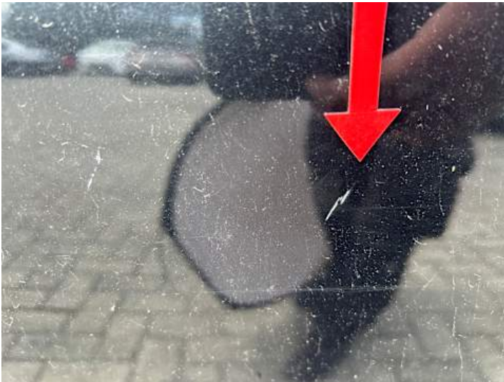
Türe hinten links (Lackschaden)
