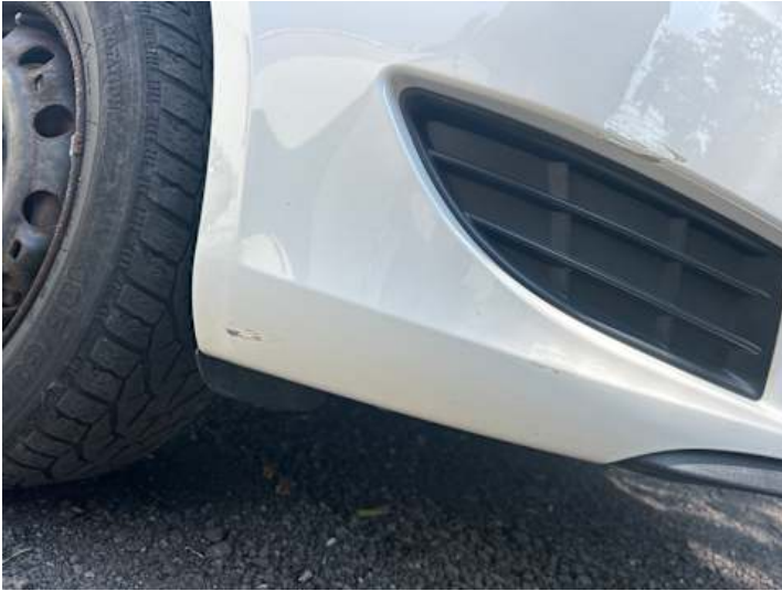
Stoßstange vorne (Kratzer, Lackschaden)
