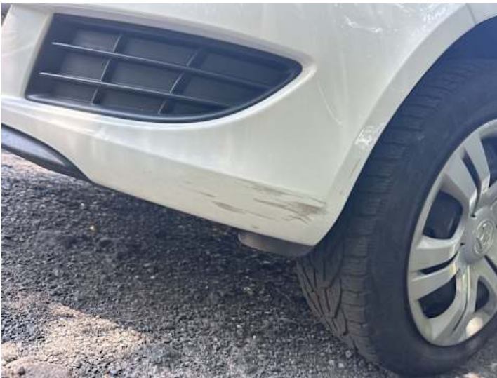
Stoßstange vorne (Kratzer, Lackschaden)
