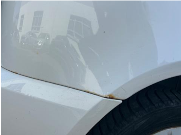
Seitenteil hinten rechts (Rost)
