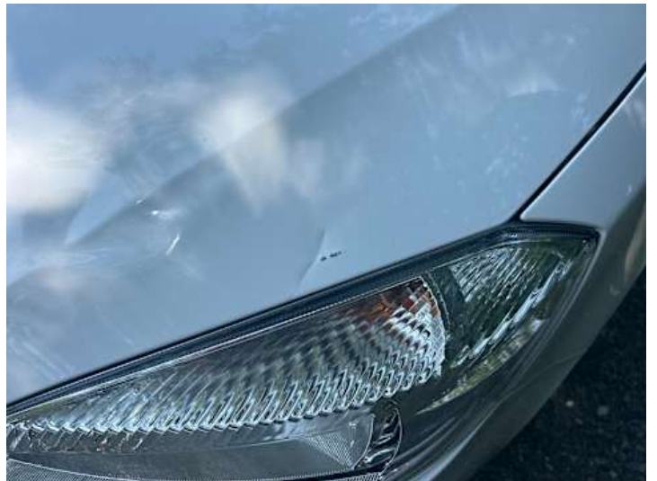
Motorhaube (Verformung, Lackschaden)
