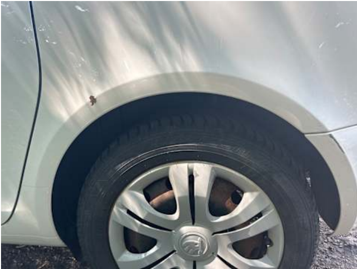
Seitenteil hinten links (Rost)
