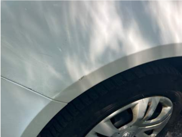
Kotflügel vorne links (Kratzer, Lackschaden, Delle)
