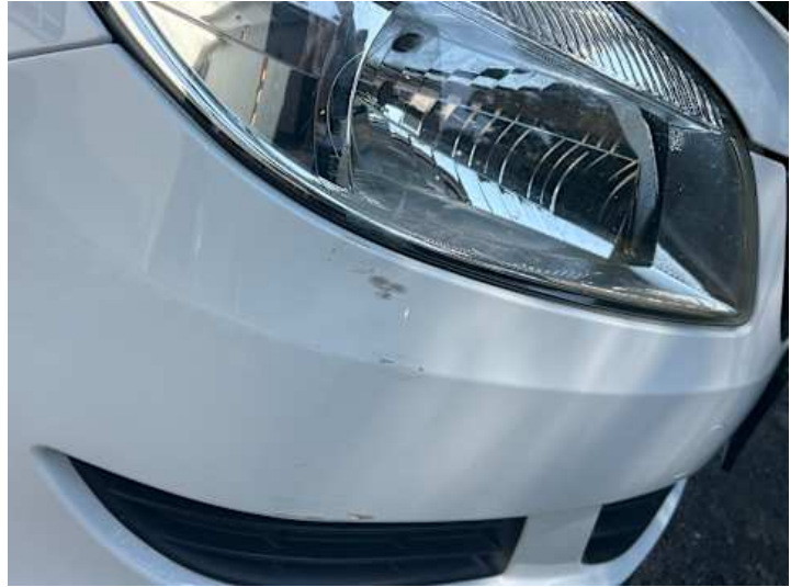
Stoßstange vorne (Kratzer, Lackschaden)
