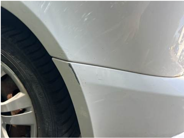
Stoßstange hinten (Kratzer, Lackschaden)
