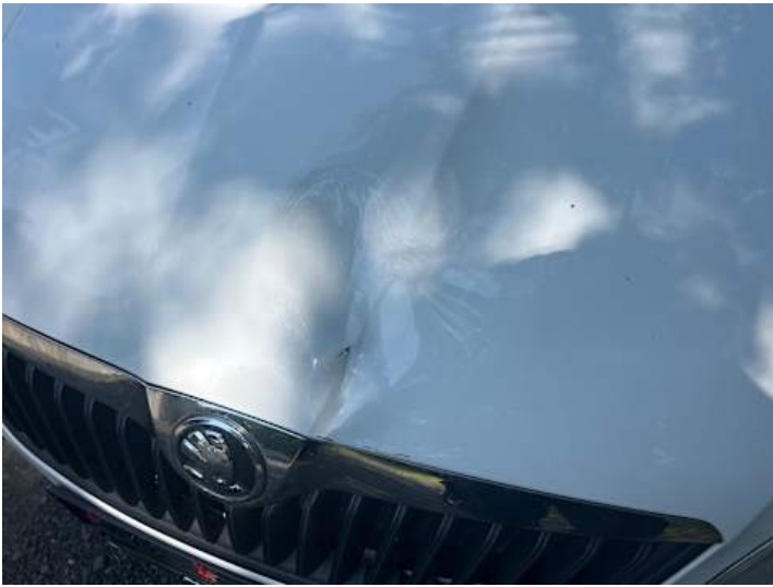
Motorhaube (Verformung, Lackschaden)
