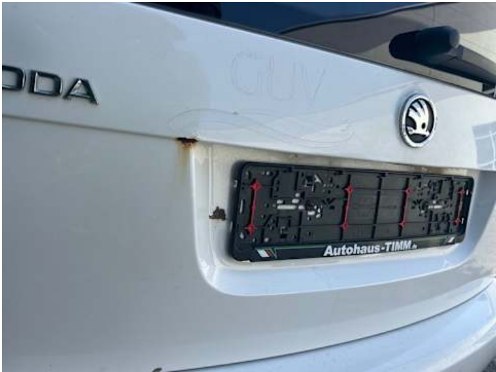
Heckklappe (Rost, Lackschaden)
