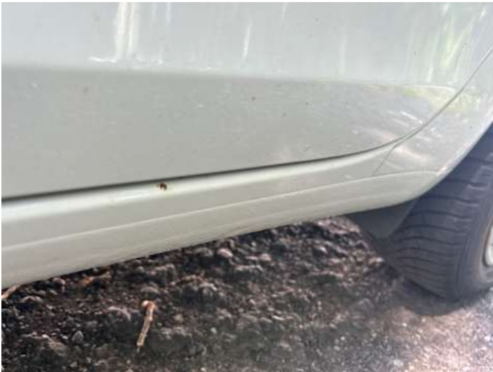
Schweller links (Rost)
