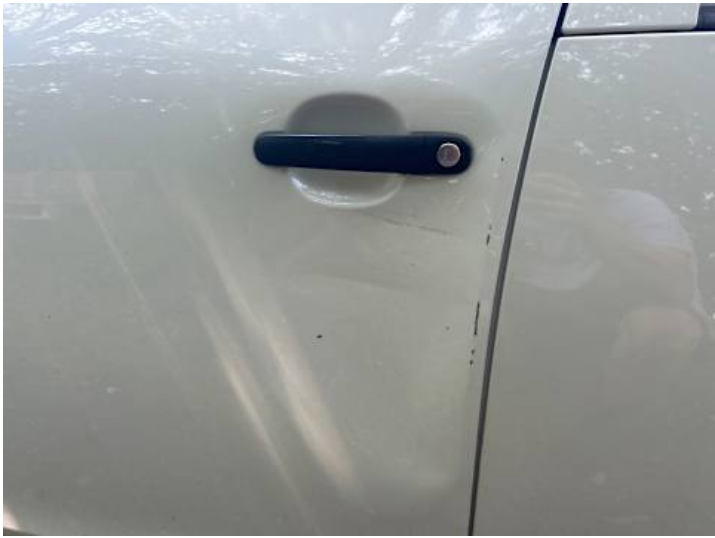
Fahrtür (Delle, Lackschaden)
