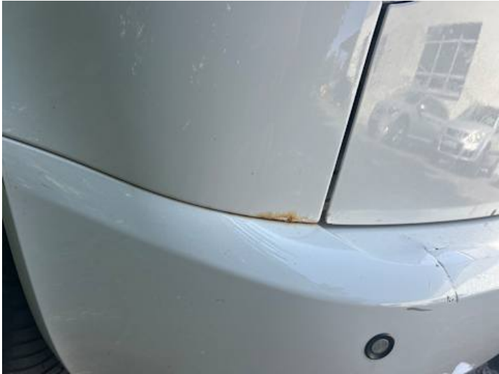
Seitenteil hinten links (Rost)
