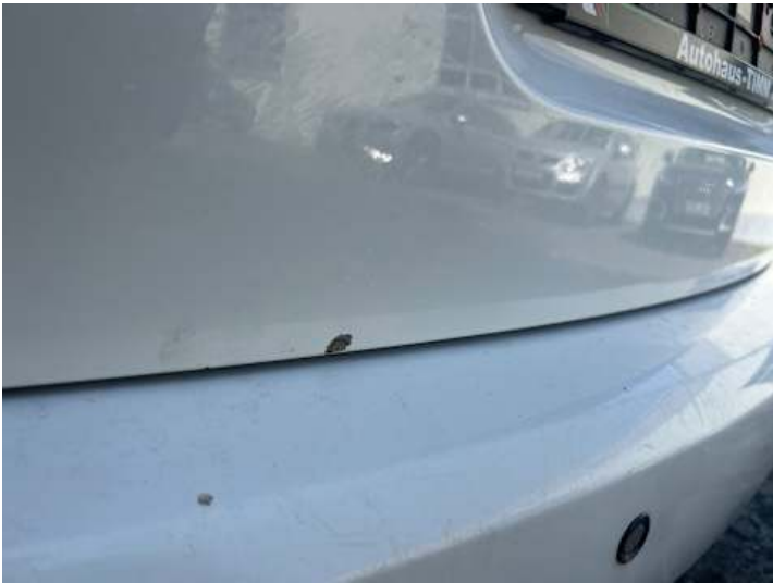
Heckklappe (Rost, Lackschaden)
