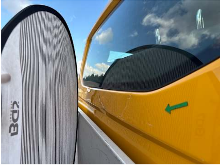
Seitenteil hinten rechts (Kratzer, Lackschaden, Verformung, Unsachgemäß instand gesetzt)
