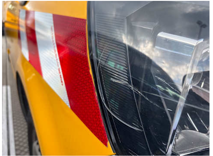
Scheinwerfer (rechts) (Riss/Bruch)
