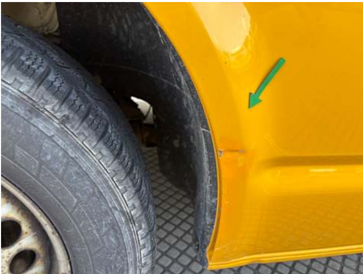
Fahrtür (Kratzer, Lackschaden, Unsachgemäß instand gesetzt)
