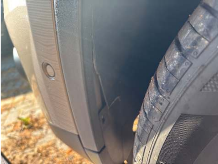
Stoßstange vorne (Unsachgemäß instand gesetzt)
