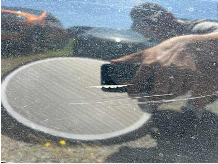
Fahrtür (Delle, Kratzer, Lackschaden)
