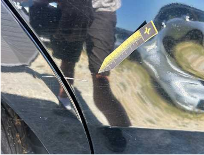
Türe hinten rechts (Delle, Kratzer)
