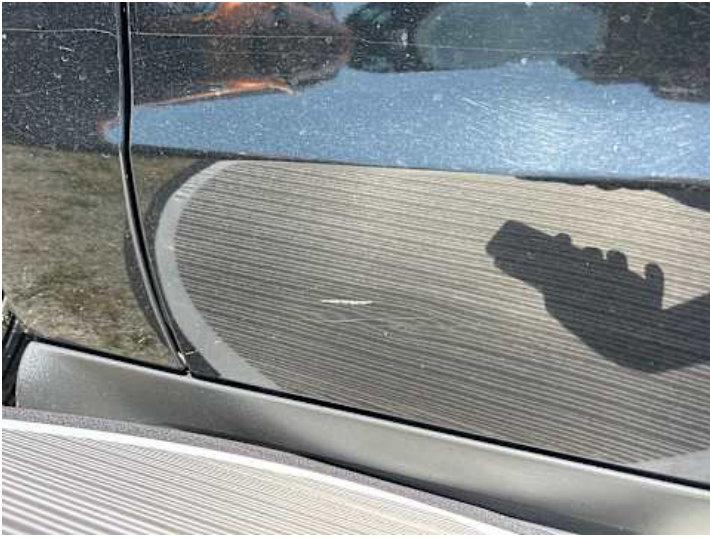
Fahrtür (Delle, Kratzer, Lackschaden)
