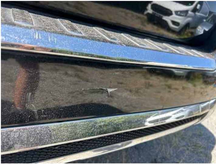
Stoßstange hinten (Riss/Bruch, Lackschaden)
