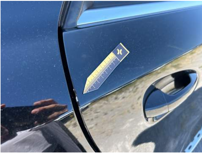
Türe hinten rechts (Kratzer)
