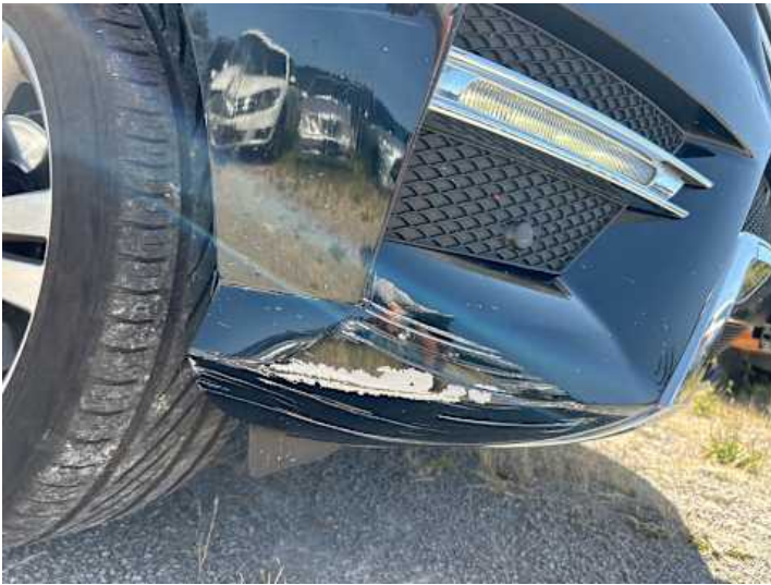
Stoßstange vorne (Kratzer, Lackschaden)
