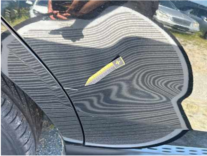
Türe hinten rechts (Delle, Kratzer)
