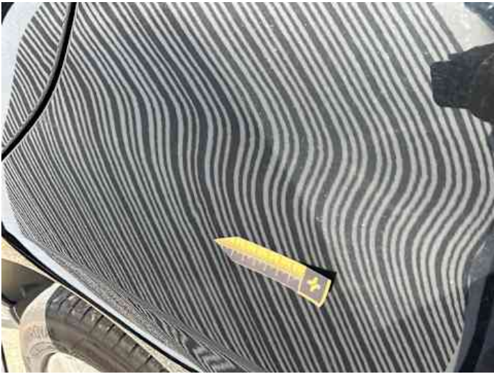
Seitenteil hinten links (Delle)
