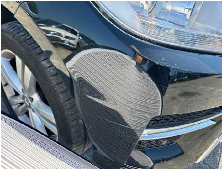
Stoßstange vorne (Lackschaden, Unsachgemäß instand gesetzt)
