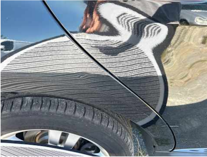
Seitenteil hinten rechts (Delle, Kratzer)
