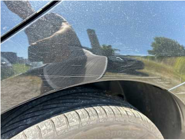
Seitenteil hinten links (Delle, Kratzer)
