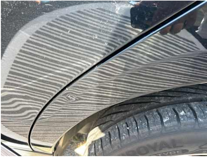
Seitenteil hinten links (Delle, Kratzer)
