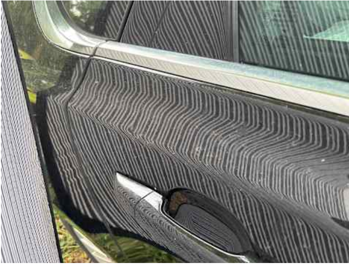
Türe hinten rechts (Delle)
