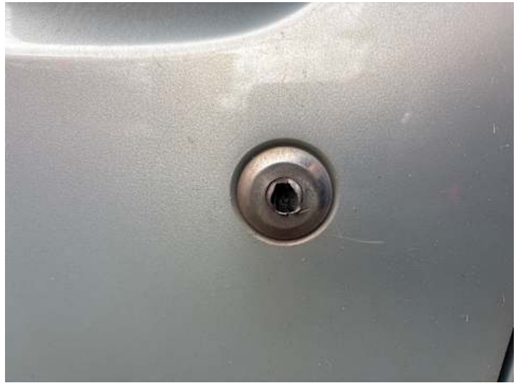
Fahrtür (Anderer Schaden): Türschloss kaputt (Teil vom Schlüssel steckt drin fest)
