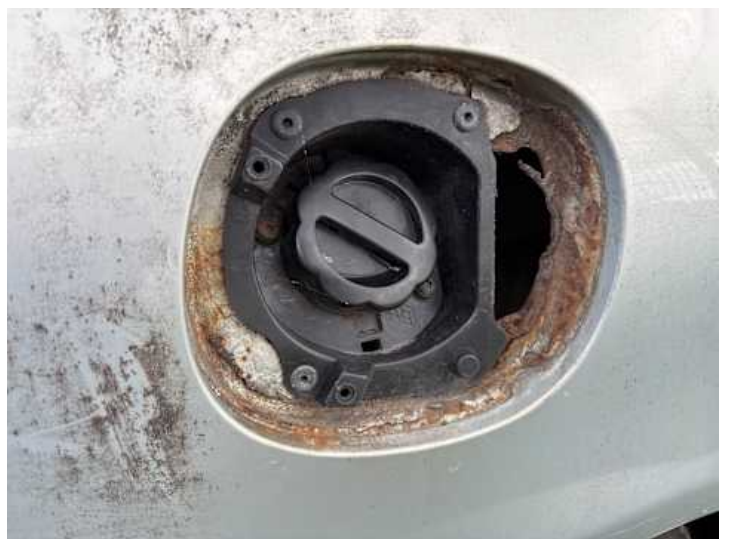
Seitenteil hinten rechts (Riss/Bruch, Rost)
