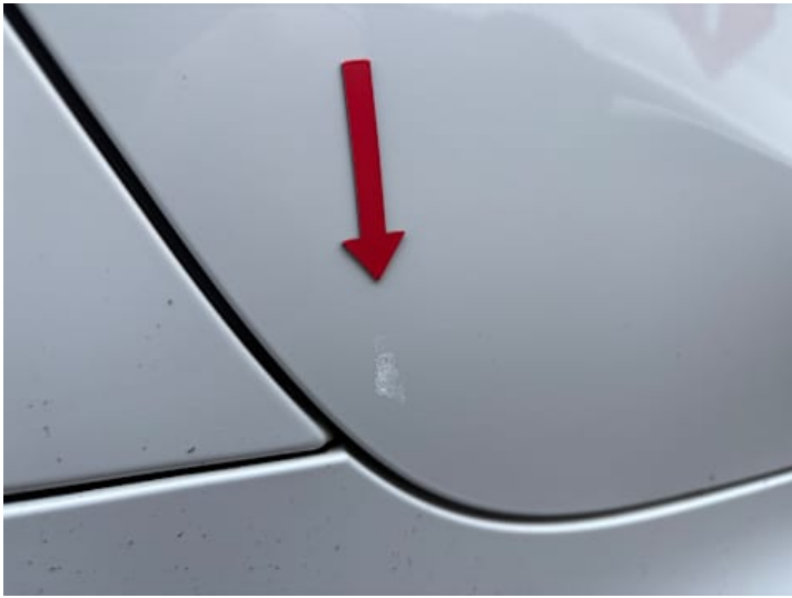
Türe hinten rechts (Unsachgemäß instand gesetzt, Lackschaden)
