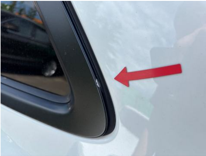
Seitenteil hinten links (Lackschaden)
