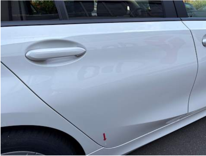
Türe hinten rechts (Unsachgemäß instand gesetzt, Lackschaden)
