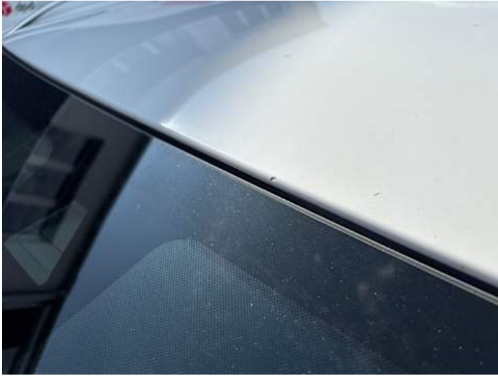
Dach (Lackschaden, Steinschlag)
