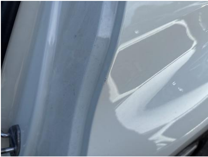
Seitenteil hinten links (Lackschaden)
