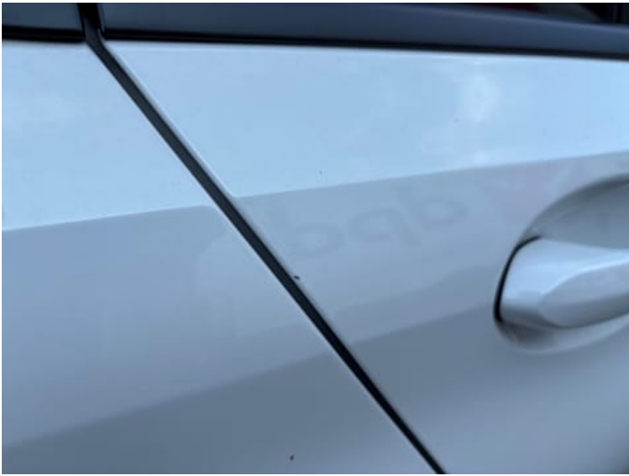
Türe hinten rechts (Unsachgemäß instand gesetzt, Lackschaden)
