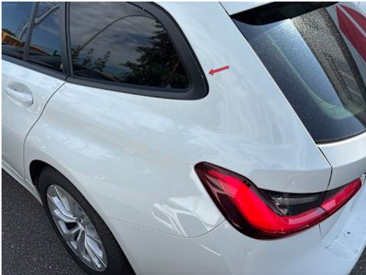
Seitenteil hinten links (Lackschaden)
