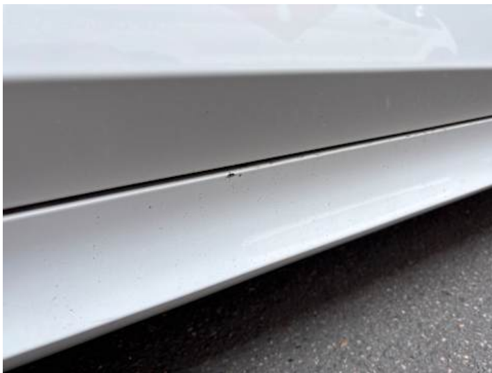
Schweller rechts (Kratzer)
