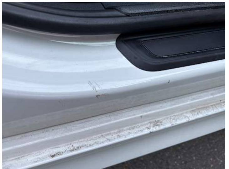
Schweller rechts (Kratzer)
