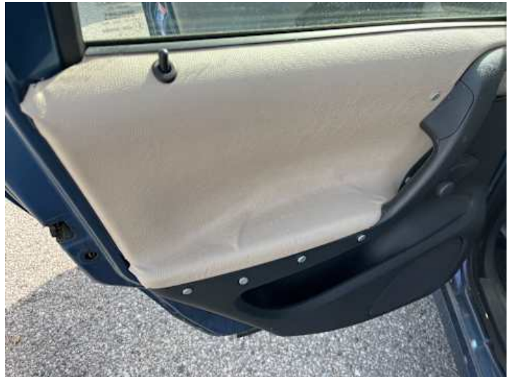
Innenraum (Anderer Schaden): falscher Bezug
