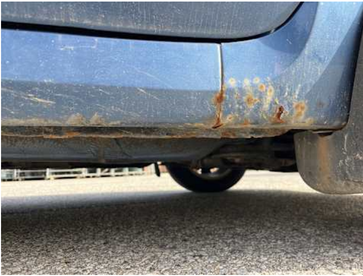
Schweller rechts (Rost)
