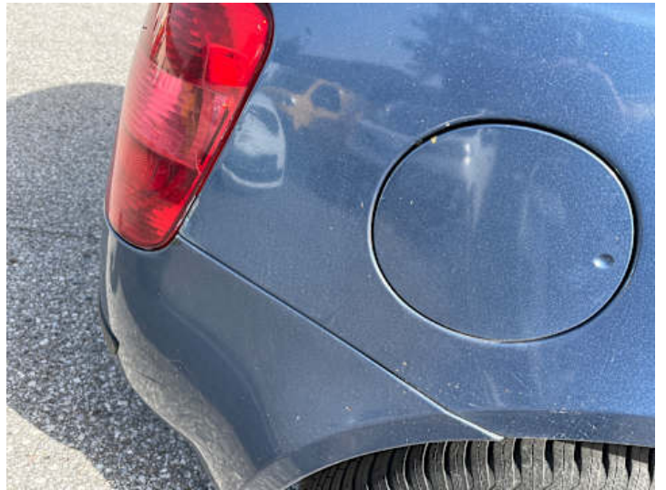
Seitenteil hinten rechts (Delle, Lackschaden)
