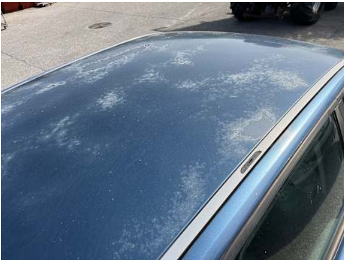
Dach (Lackschaden, Ausgeblichen/Matt)
