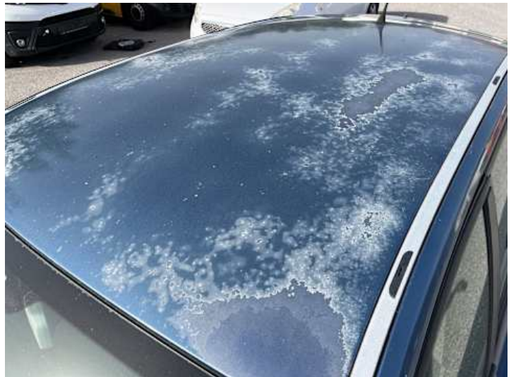
Dach (Lackschaden, Ausgeblichen/Matt)
