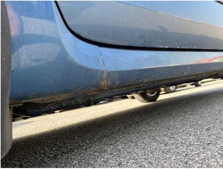
Schweller links (Rost)
