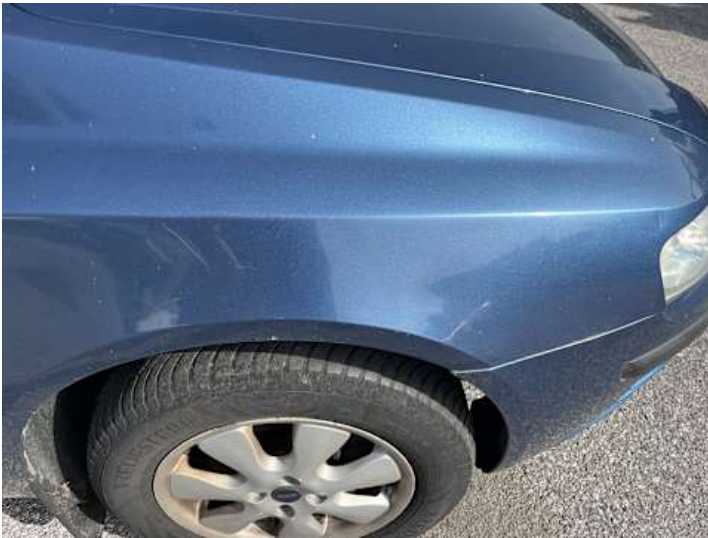
Kotflügel vorne rechts (Delle, Kratzer, Rost)
