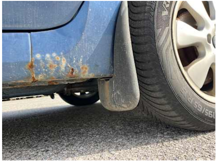
Kotflügel vorne rechts (Delle, Kratzer, Rost)
