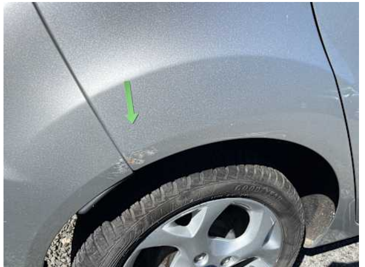
Seitenteil hinten rechts (Kratzer, Rost)
