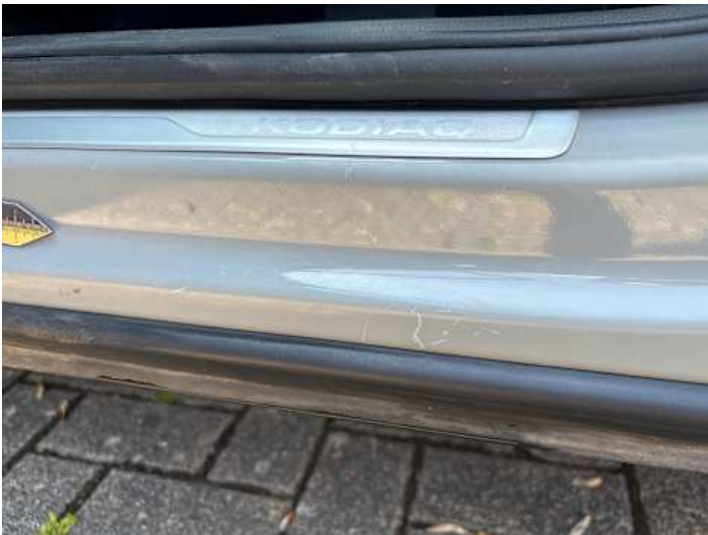
Schweller links (Kratzer)
