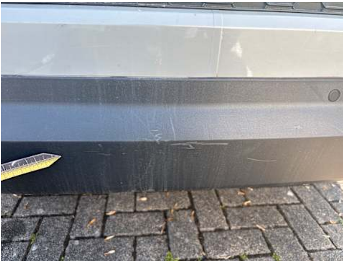
Stoßstange hinten (Kratzer)
