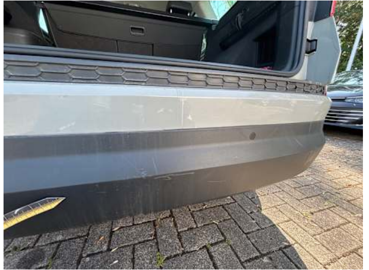
Stoßstange hinten (Kratzer)
