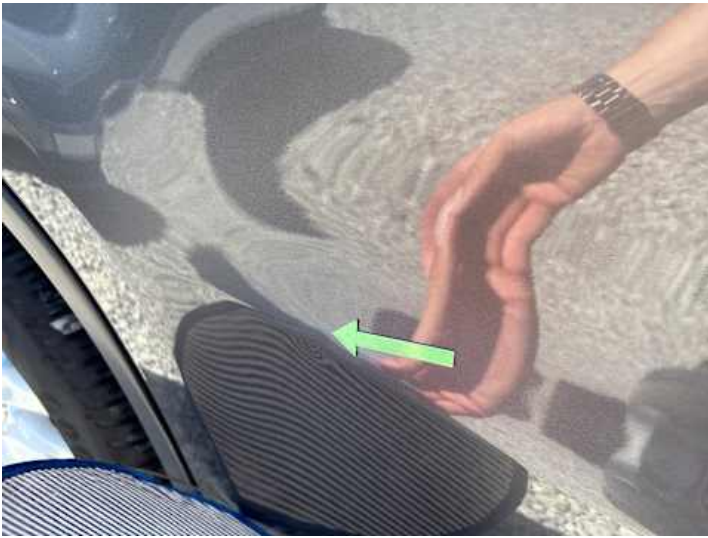
Türe hinten rechts (Delle)
