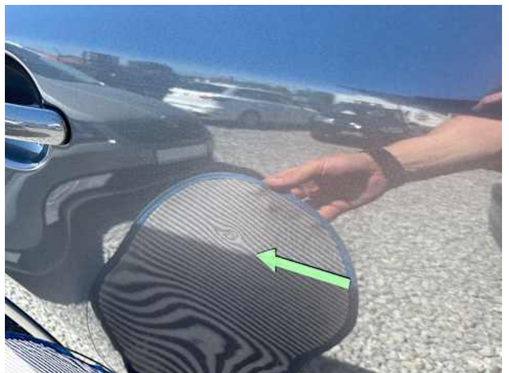
Türe hinten rechts (Delle)
