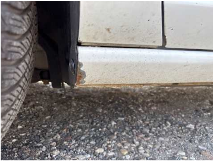
Schweller links (Rost)
