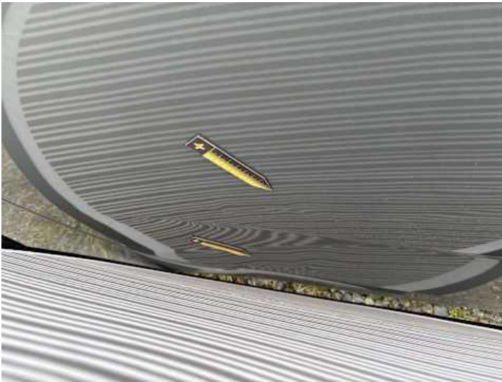
Türe hinten rechts (Verformung, Kratzer)
