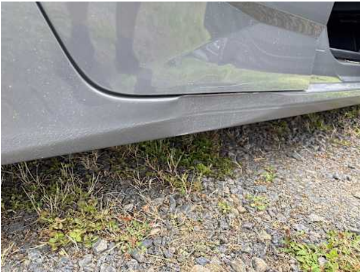
Schweller rechts (Verformung, Kratzer)
