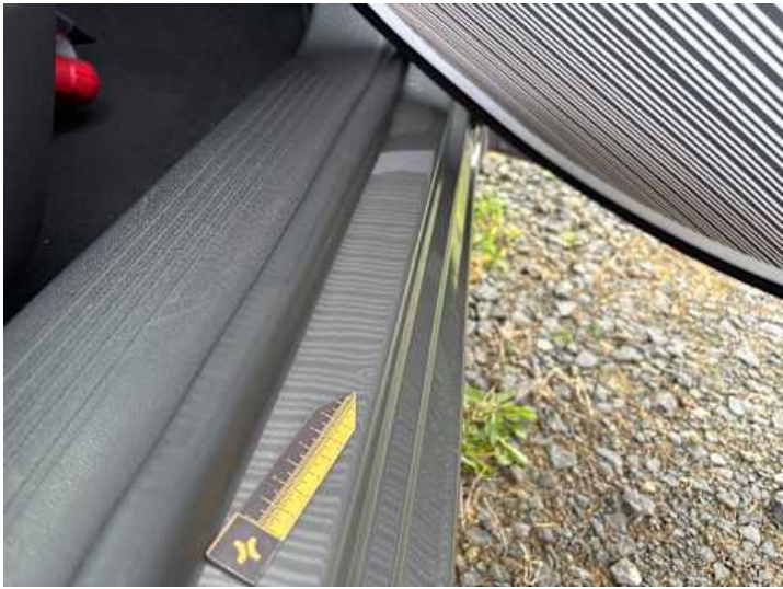
Schweller rechts (Delle)
