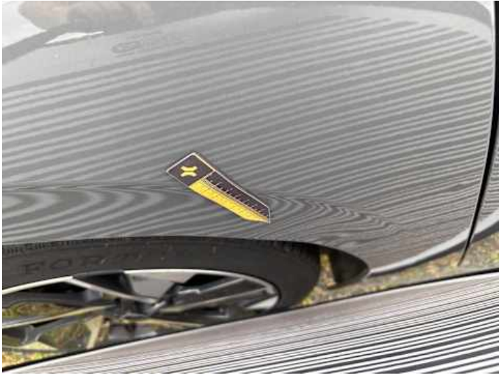
Seitenteil hinten rechts (Verformung)
