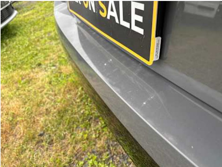
Stoßstange hinten (Kratzer, Verformung)
