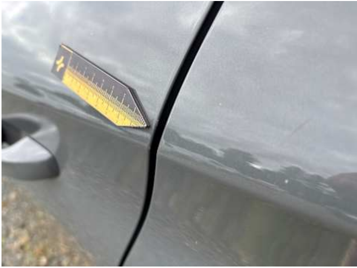
Türe hinten links (Kratzer)
