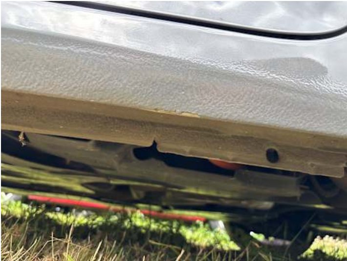
Schweller links (Lackschaden)
