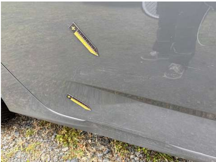
Türe hinten rechts (Verformung, Kratzer)
