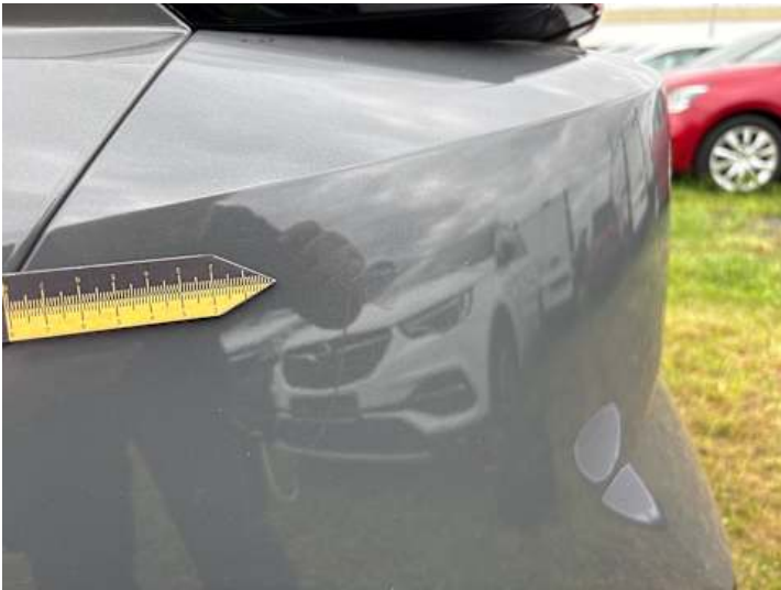
Stoßstange hinten (Kratzer, Verformung)
