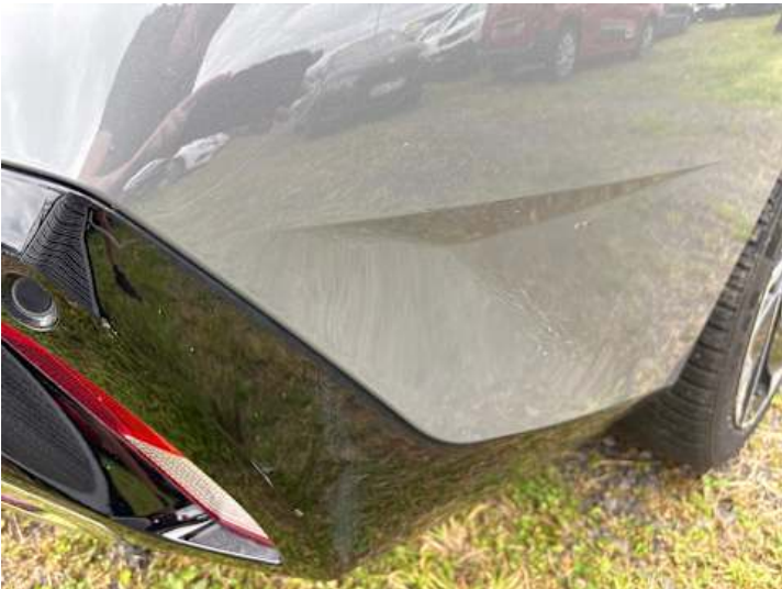
Stoßstange hinten (Kratzer, Verformung)
