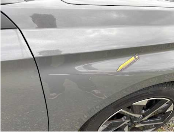
Kotflügel vorne rechts (Kratzer)
