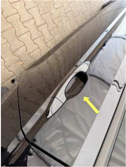
Türe hinten links (Kratzer)
