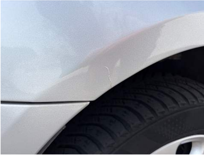
Kotflügel vorne links (Lackschaden, Riss/Bruch)
