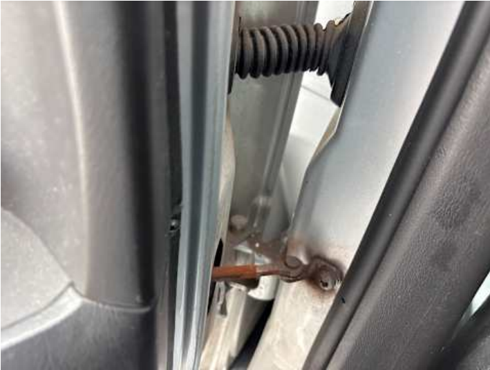
Türe hinten links (Anderer Schaden): Schwergängig
