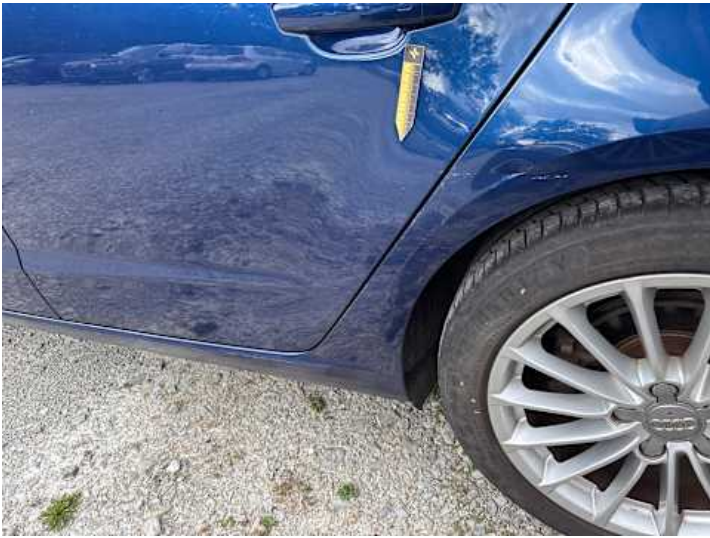
Türe hinten links (Lackschaden, Verformung)
