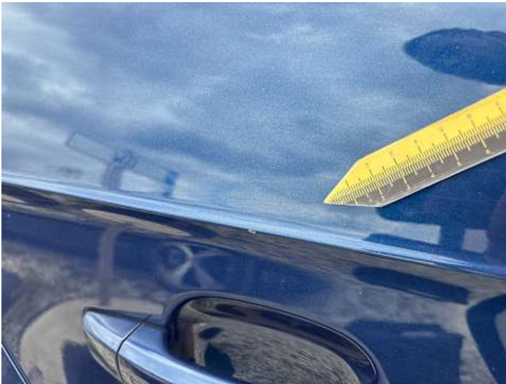
Türe hinten rechts (Lackschaden)
