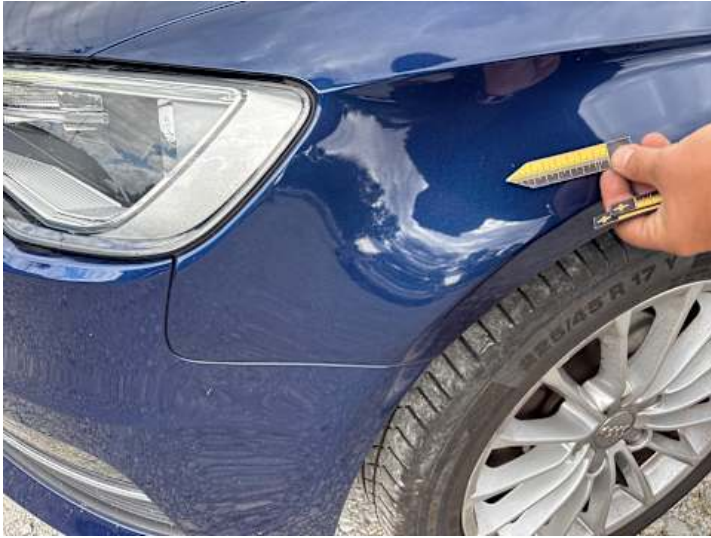
Kotflügel vorne links (Steinschlag)
