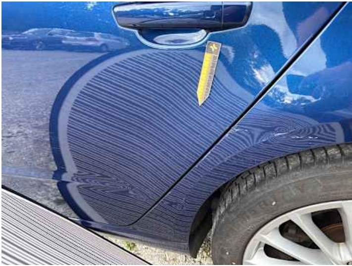
Türe hinten links (Lackschaden, Verformung)
