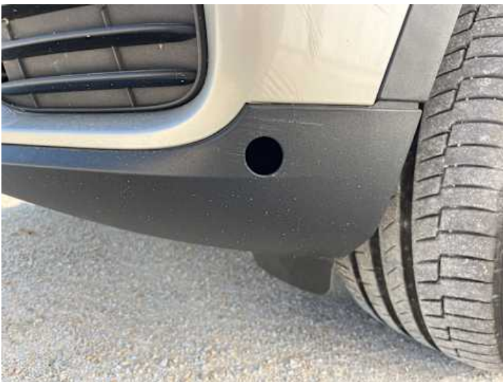
Stoßstange vorne (Anderer Schaden): PDC fehlt
