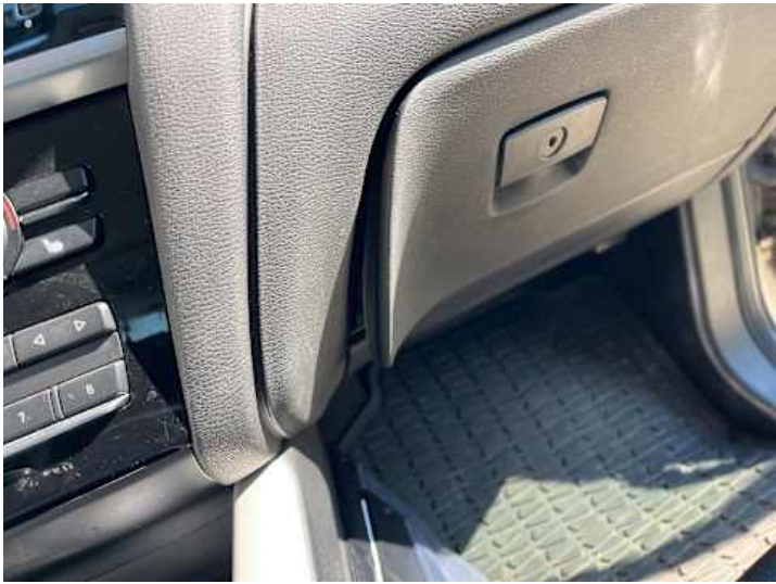
Innenraum (Anderer Schaden): Deckel löst sich ab
