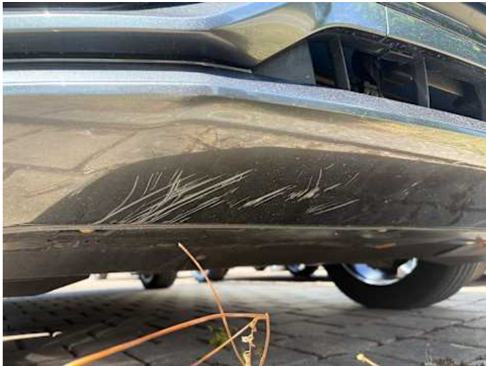
Stoßstange vorne (Lackschaden)
