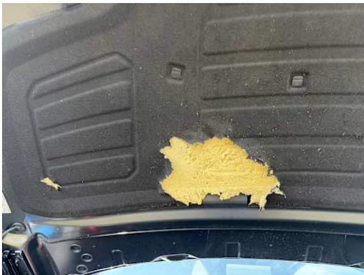
Motorhaube (Anderer Schaden): Beschädigung Dämmmatte
