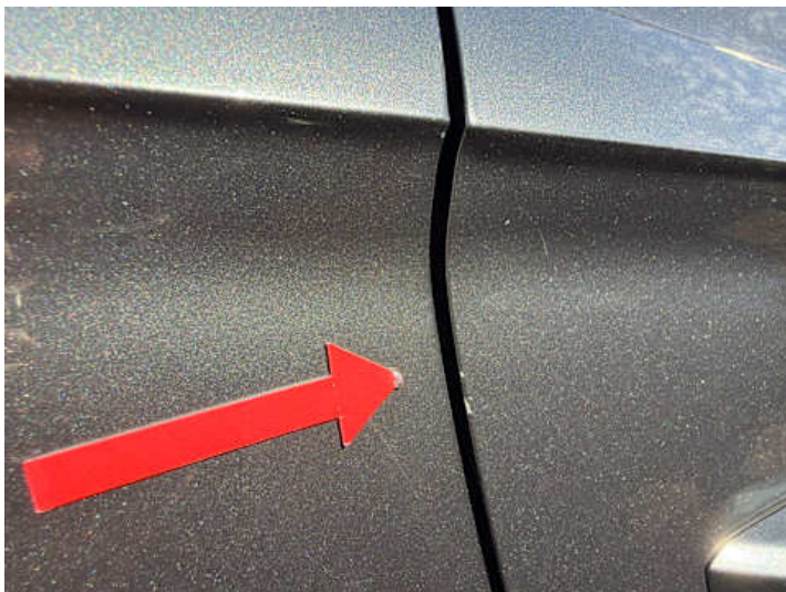
Türe hinten rechts (Lackschaden)
