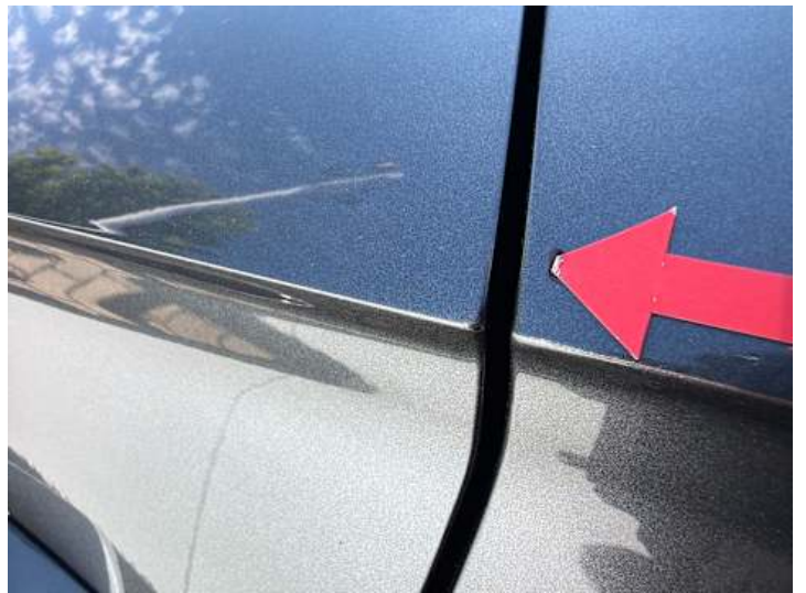
Türe hinten links (Lackschaden)
