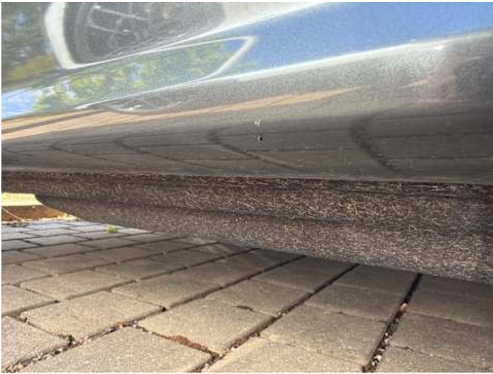
Schweller links (Lackschaden)
