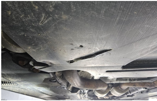
Unterbodenverkleidung gebrochen (DEKRA)
