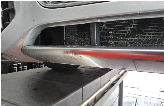
Stoßfänger vorn deformiert und verschrammt (DEKRA)
