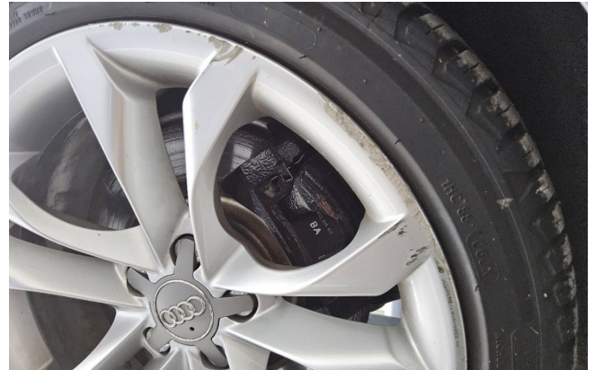
4x LM-Felge verschrammt, zerkratzt mit Materialabtrag (DEKRA)
