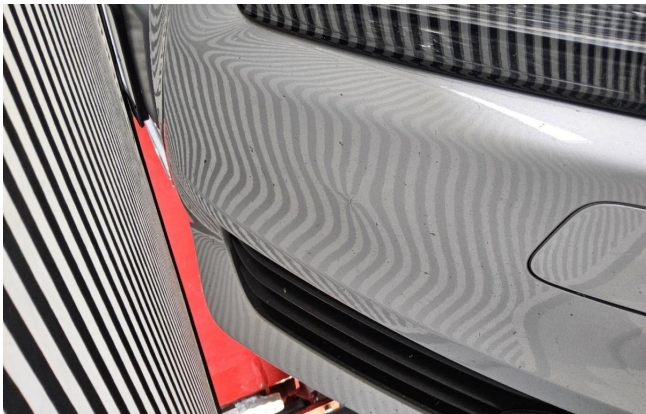
Stoßfänger vorn deformiert und verschrammt (DEKRA)
