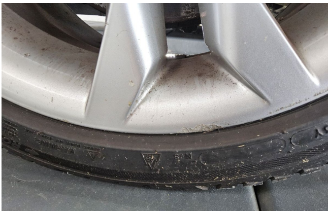
4x LM-Felge verschrammt, zerkratzt mit Materialabtrag (DEKRA)
