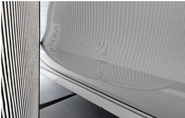
Tür vorn rechts deformiert (DEKRA)
