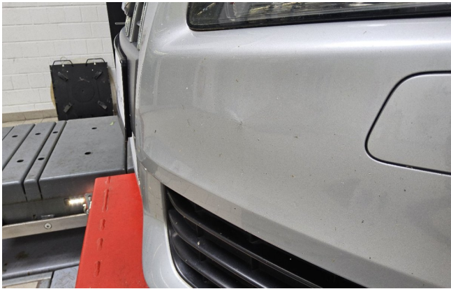
Stoßfänger vorn deformiert und verschrammt (DEKRA)
