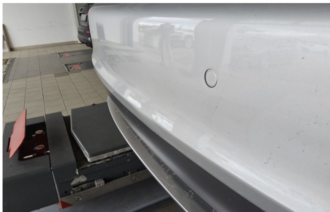
Sensor Einparkhilfe hinten rechts mitte lose (DEKRA)
