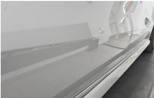
Tür vorn rechts deformiert (DEKRA)
