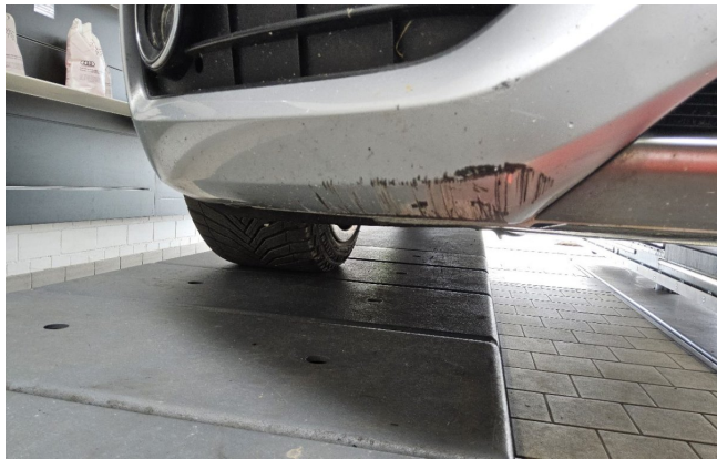
Stoßfänger vorn deformiert und verschrammt (DEKRA)
