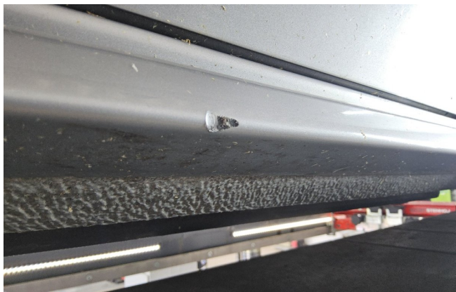
Zierleiste Schweller rechts verschrammt (DEKRA)
