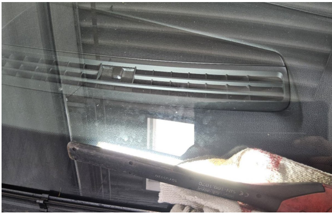
Steinschlag mit Rissbildung (DEKRA)
