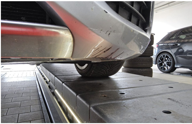
Stoßfänger vorn deformiert und verschrammt (DEKRA)
