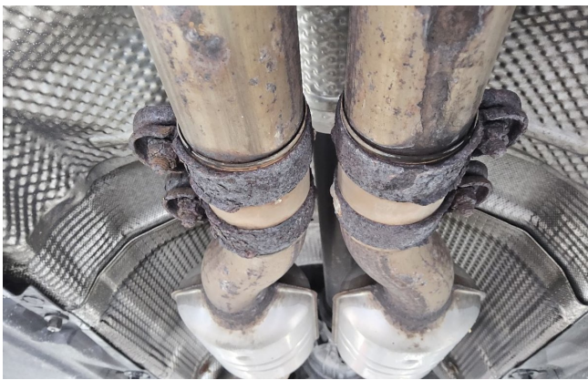
2x Doppelrohrschelle der Abgasanlage korodiert (DEKRA)
