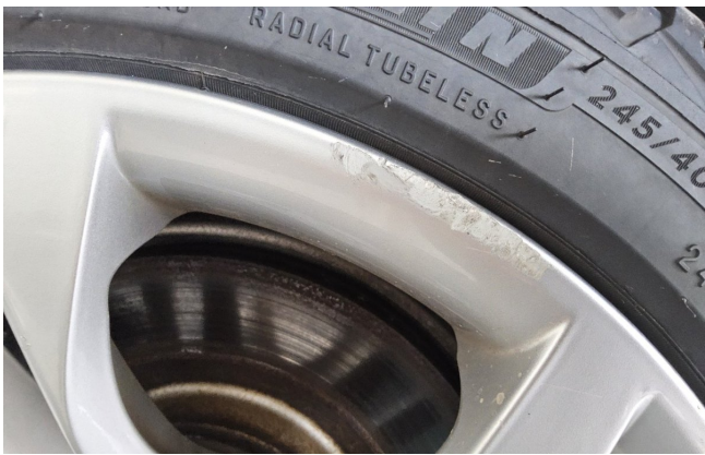
4x LM-Felge verschrammt, zerkratzt mit Materialabtrag (DEKRA)
