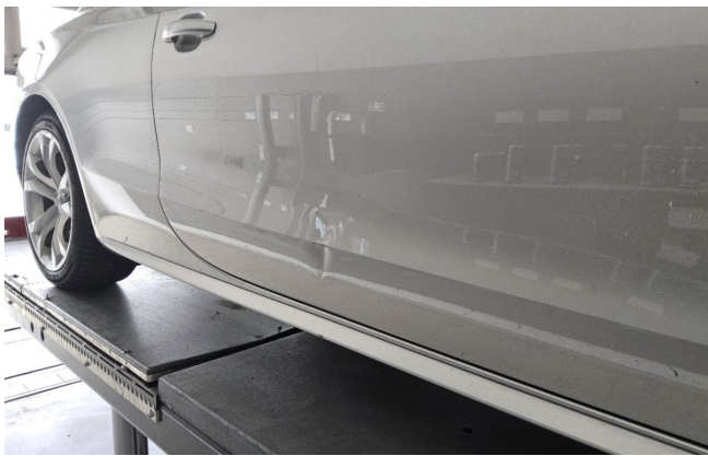
Tür vorn rechts deformiert (DEKRA)
