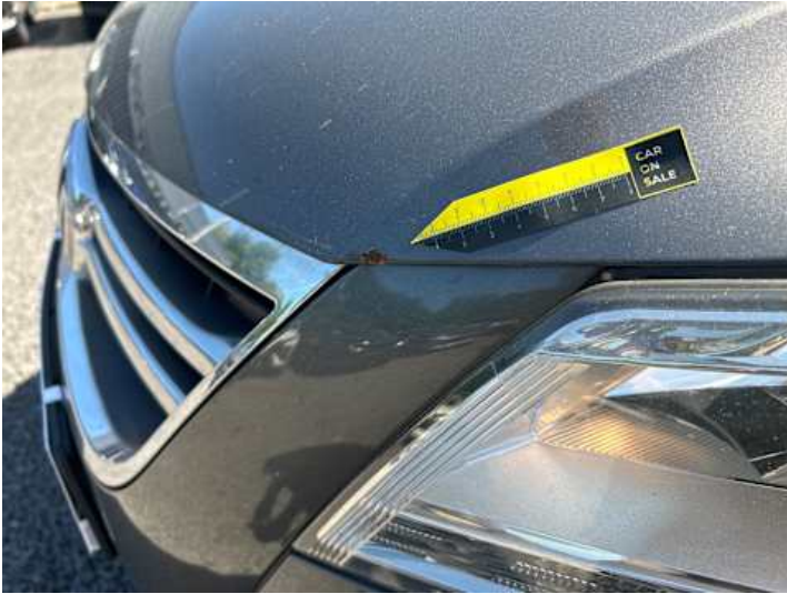
Motorhaube (Steinschlag, Rost)
