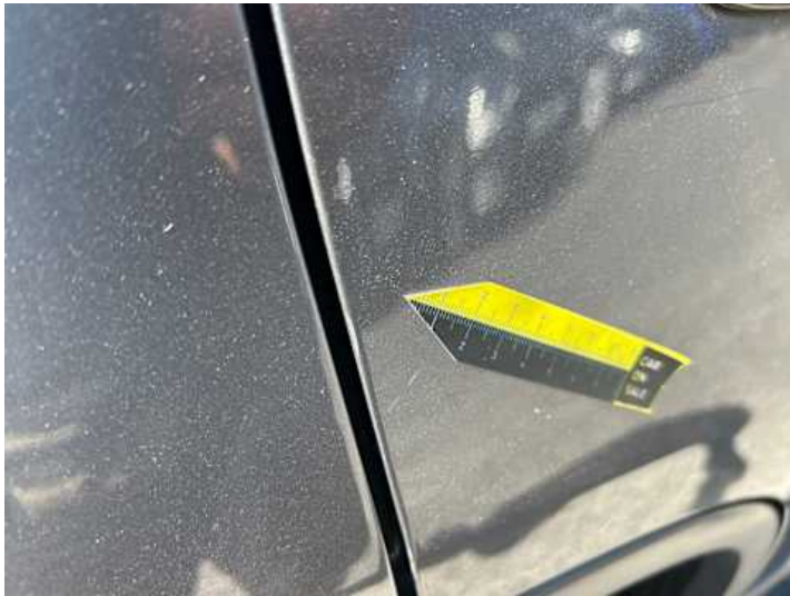
Türe hinten rechts (Kratzer)
