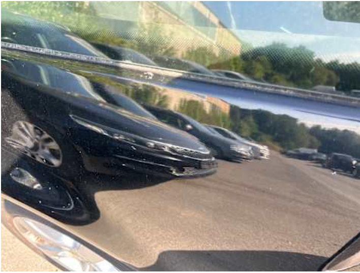
Seitenteil hinten rechts (Unsachgemäß instand gesetzt)
