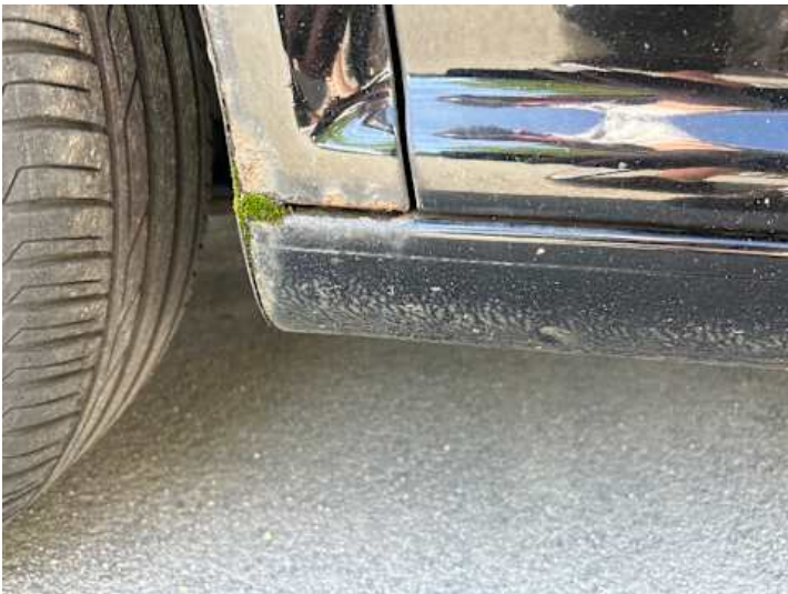
Schweller links (Rost)
