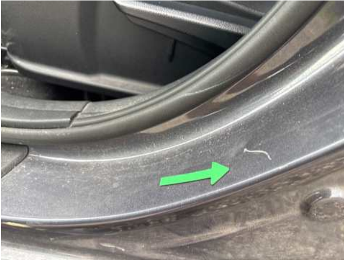
Schweller links (Kratzer, Delle)
