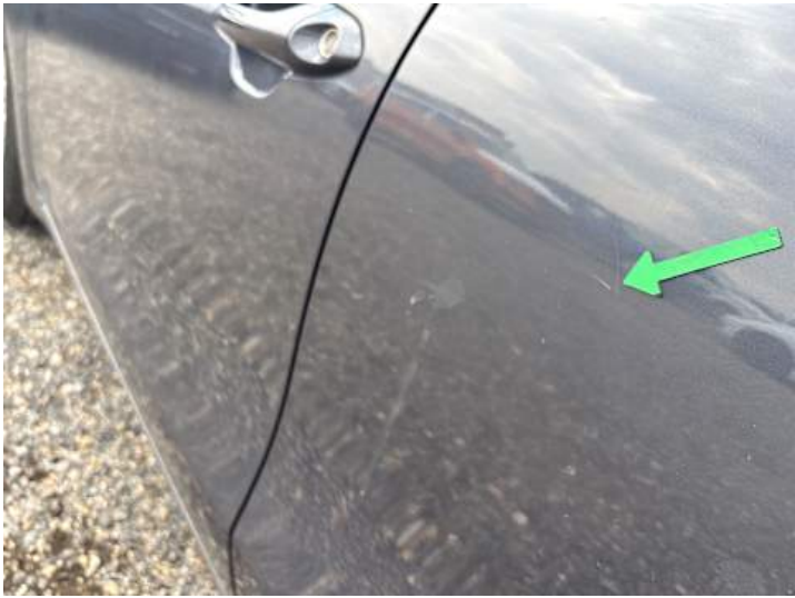
Türe hinten links (Kratzer)
