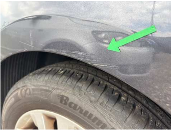
Seitenteil hinten rechts (Kratzer, Lackschaden, Unsachgemäß instand gesetzt)
