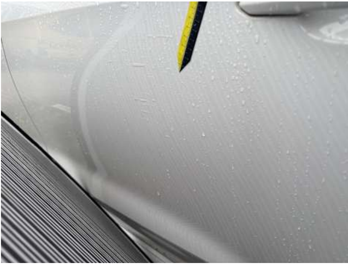
Türe hinten links (Delle)
