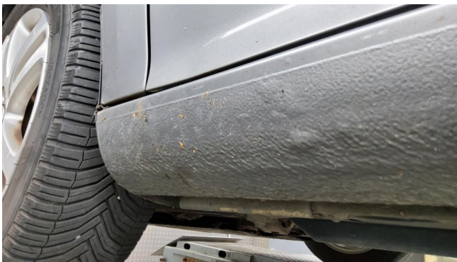
Schweller links Rost lackieren
