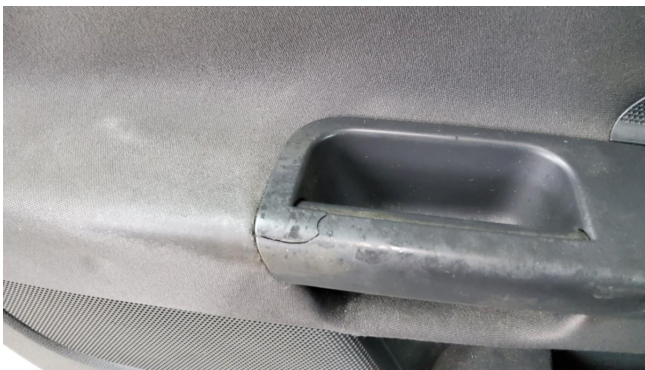
Türgriff VL innen beschädigt ern.
