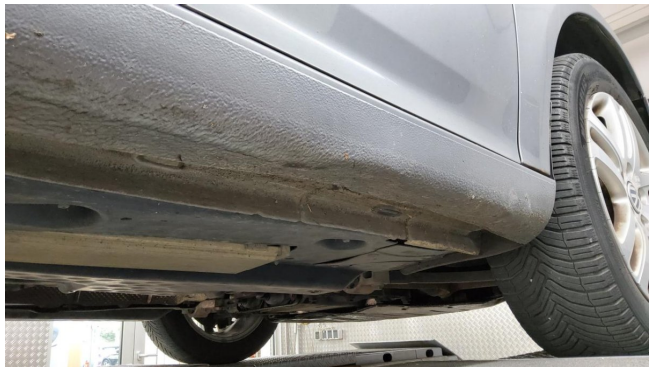
Schweller rechts verformt instandsetzen
