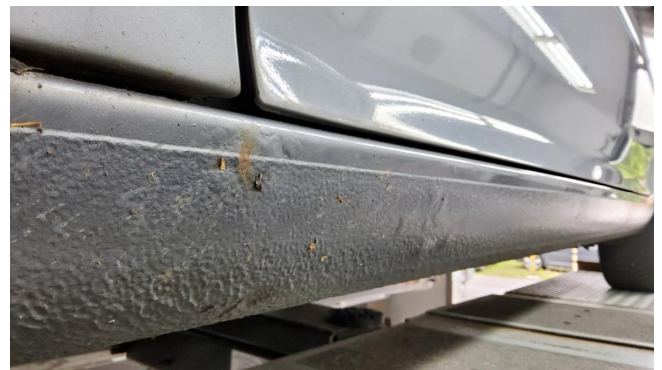
Schweller links Rost lackieren
