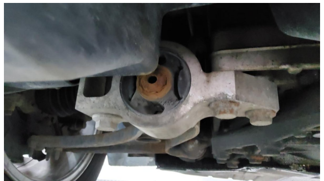
Querlenker Lagerböcke VA eingerissen ern
