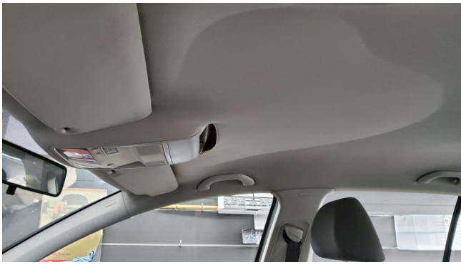
Dachhimmelverkleidung löst sich ab, Minderwert
