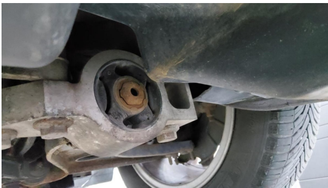
Querlenker Lagerböcke VA eingerissen ern
