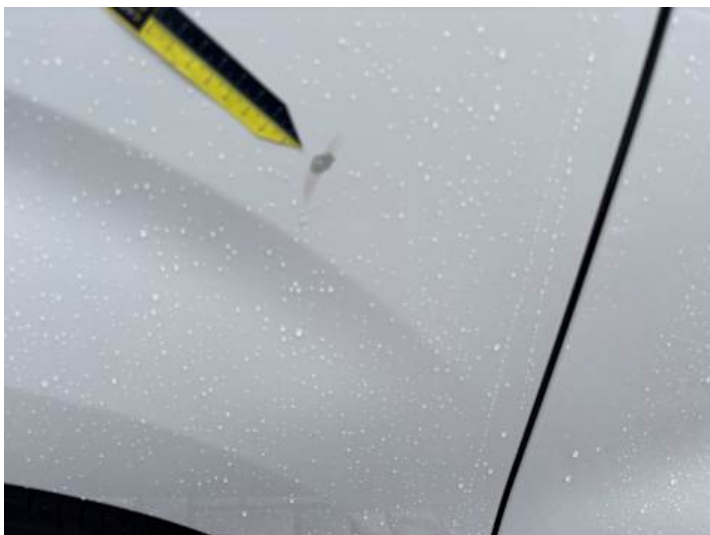
Seitenteil hinten rechts (Lackschaden)
