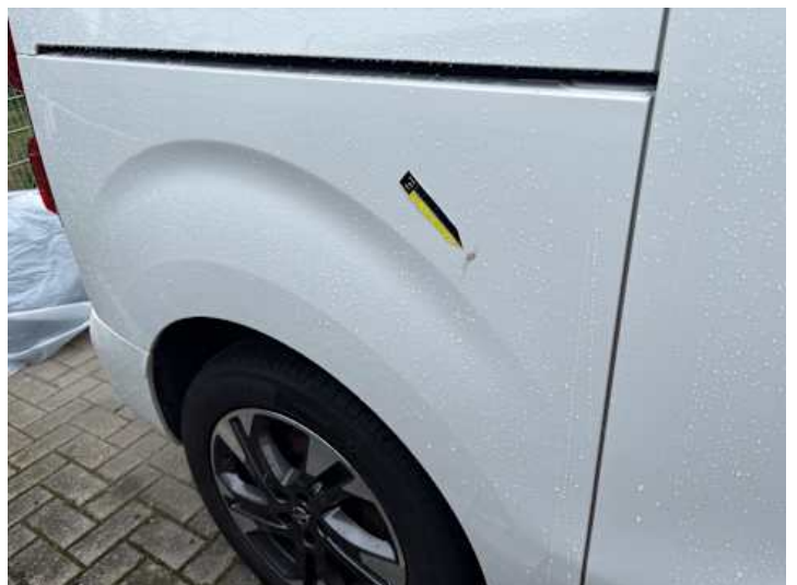
Seitenteil hinten rechts (Lackschaden)
