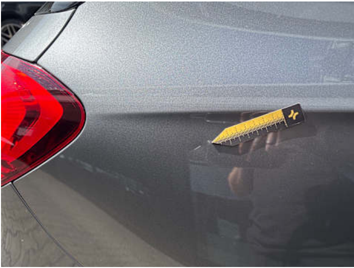
Seitenteil hinten rechts (Delle, Kratzer)
