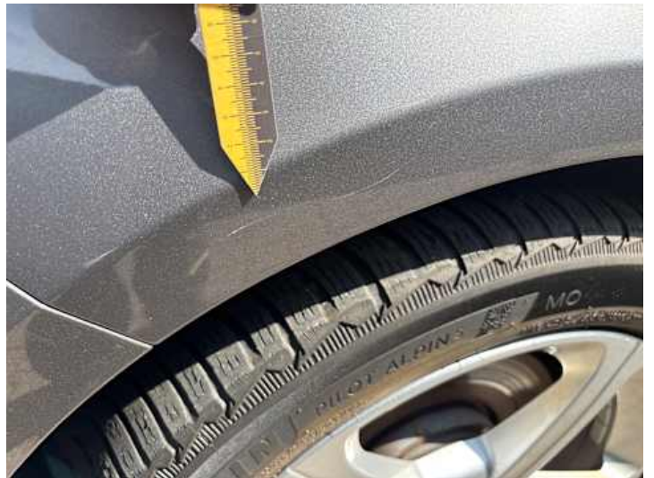
Kotflügel vorne links (Kratzer)
