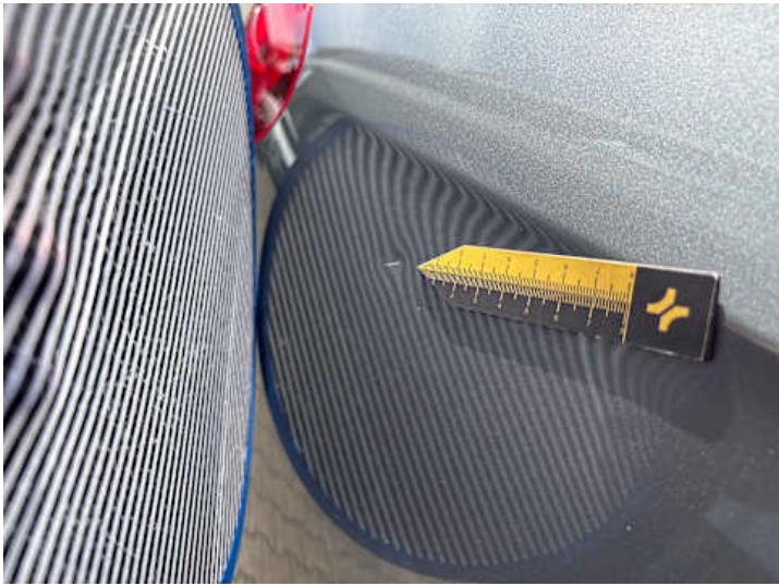
Seitenteil hinten rechts (Delle, Kratzer)
