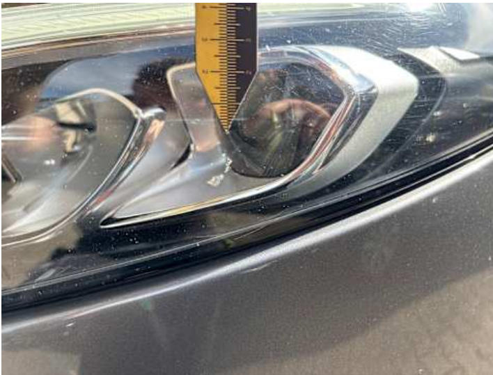
Scheinwerfer (links) (Riss/Bruch, Steinschlag)
