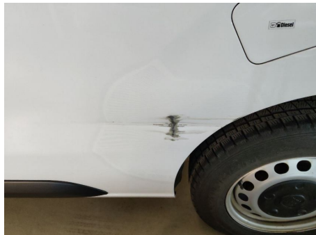
Seitenwand / Hinten Links / Delle
