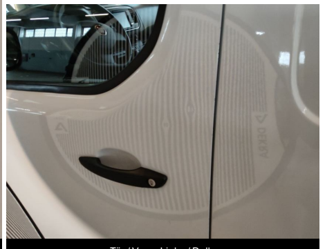
Tür / Vorne Links / Delle
