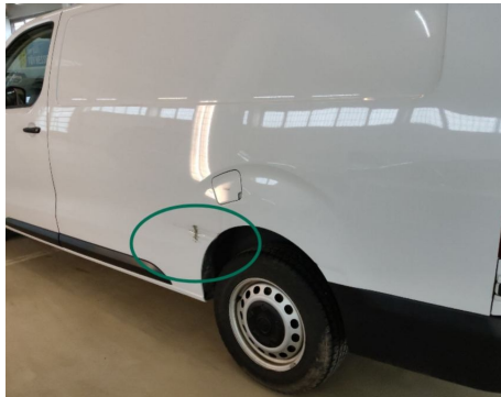
Seitenwand / Hinten Links / Delle
