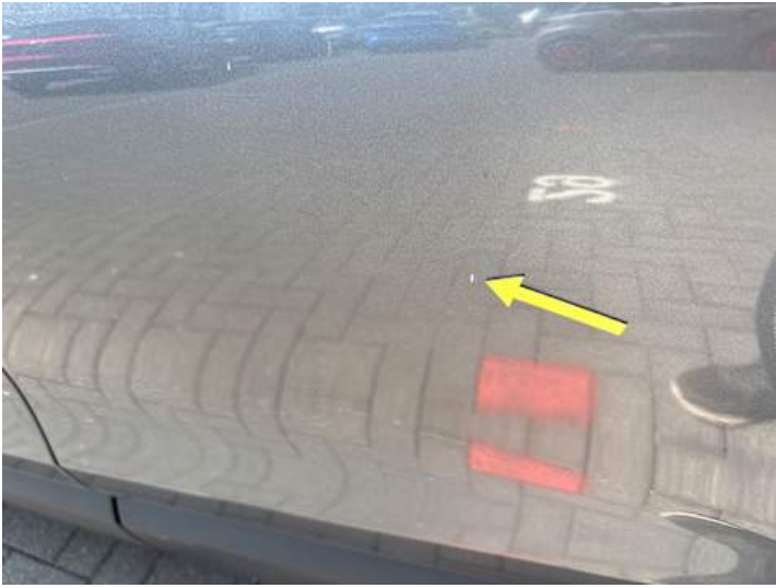
Türe hinten links (Kratzer)
