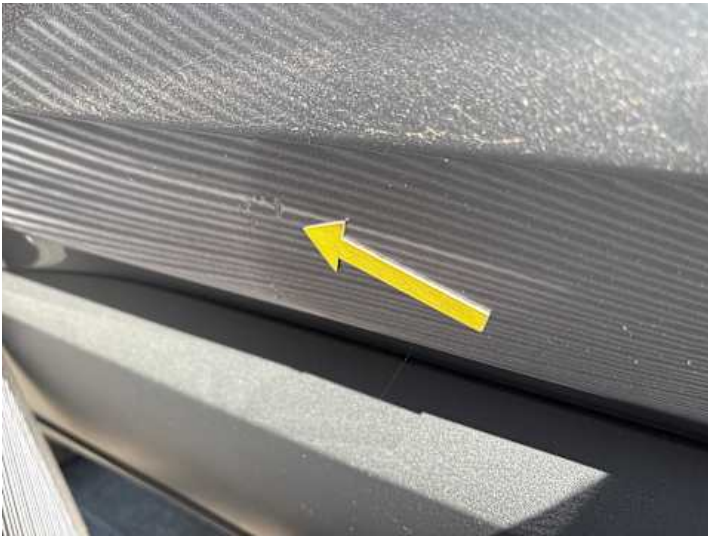
Türe hinten rechts (Kratzer, Delle)
