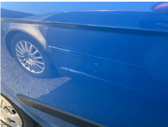
Türe hinten rechts (Lackschaden, Delle)
