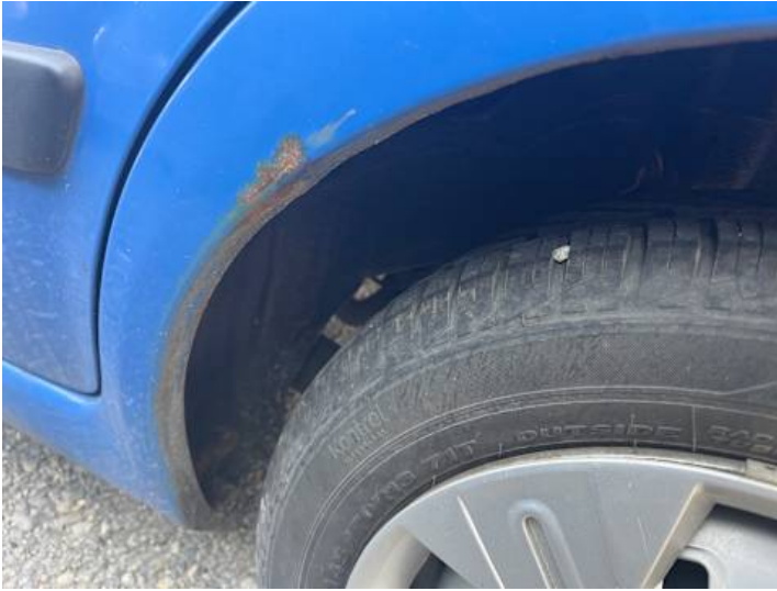
Seitenteil hinten links (Rost, Lackschaden)
