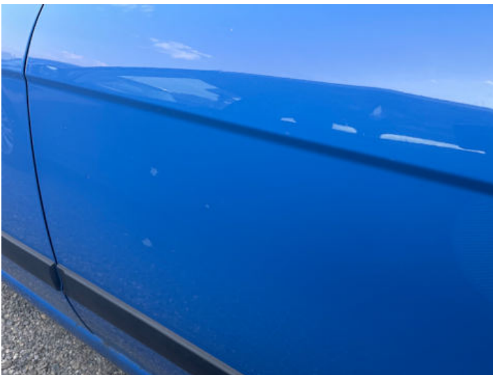
Türe hinten links (Lackschaden)
