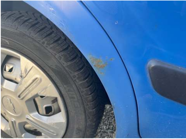
Seitenteil hinten rechts (Rost, Lackschaden)
