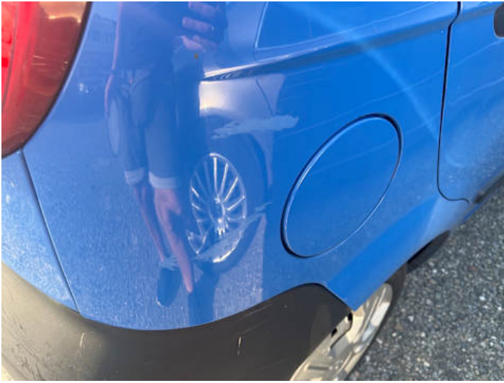
Seitenteil hinten rechts (Rost, Lackschaden)
