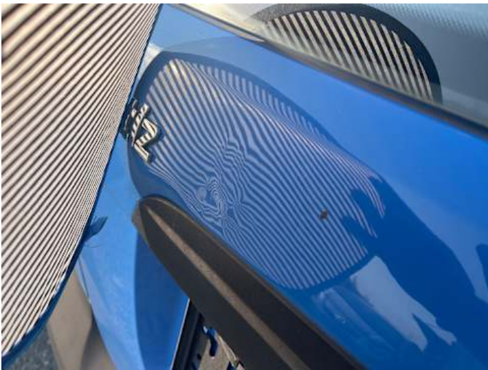
Heckklappe (Delle, Verformung)
