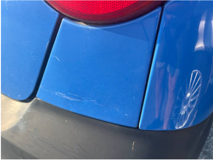
Seitenteil hinten rechts (Rost, Lackschaden)
