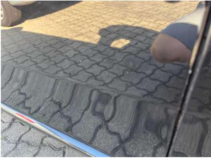
Fahrtür (Kratzer, Lackschaden, Delle)
