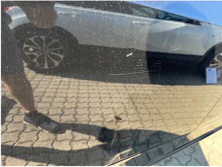
Türe hinten rechts (Kratzer, Lackschaden, Delle)
