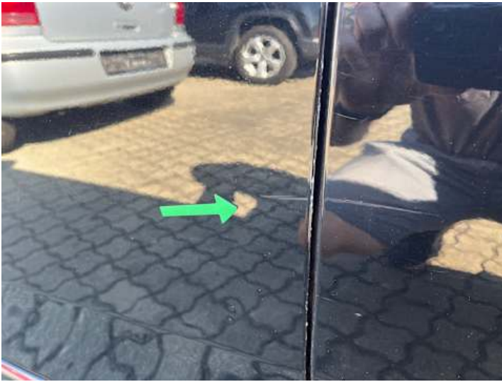
Fahrrertür (Kratzer, Lackschaden, Delle)
