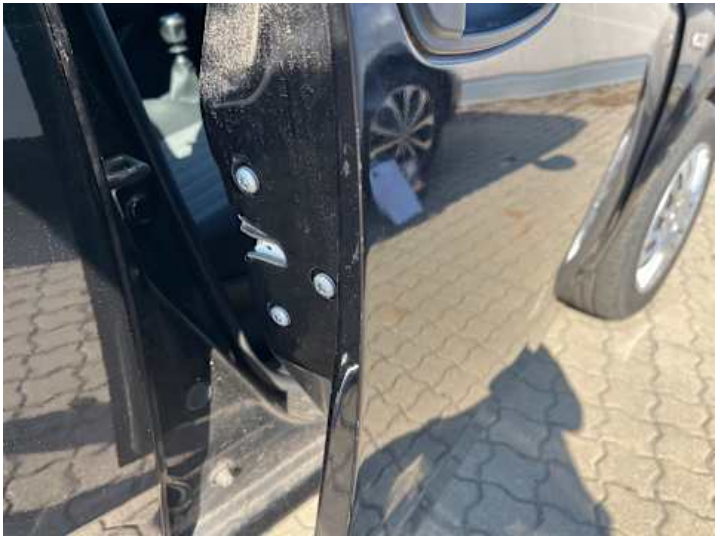
Beifahrertür (Kratzer, Lackschaden)
