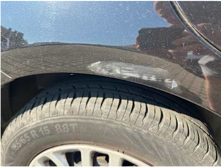
Seitenteil hinten rechts (Lackschaden)
