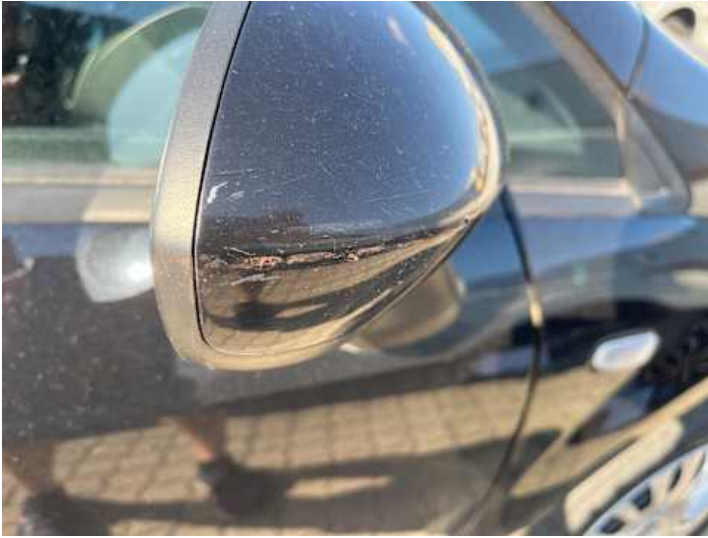
Beifahrertür (Kratzer, Lackschaden)
