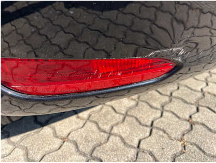
Stoßstange hinten (Kratzer, Lackschaden)
