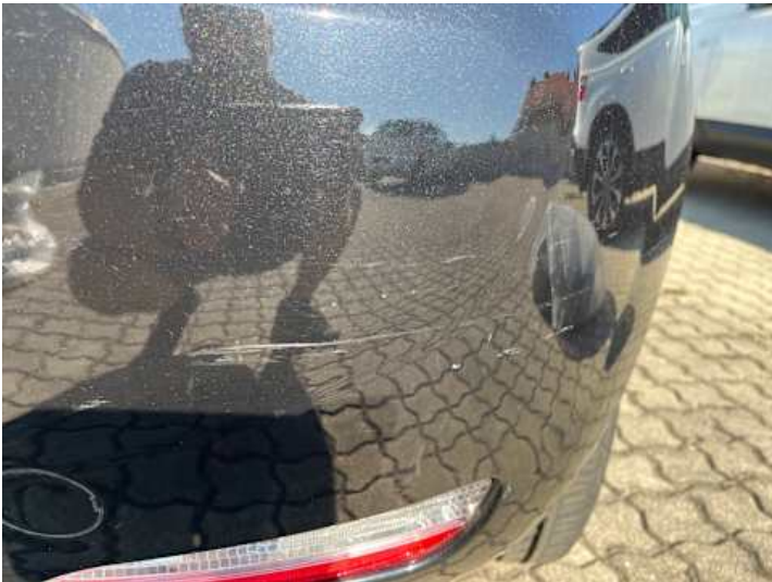
Stoßstange hinten (Kratzer, Lackschaden)
