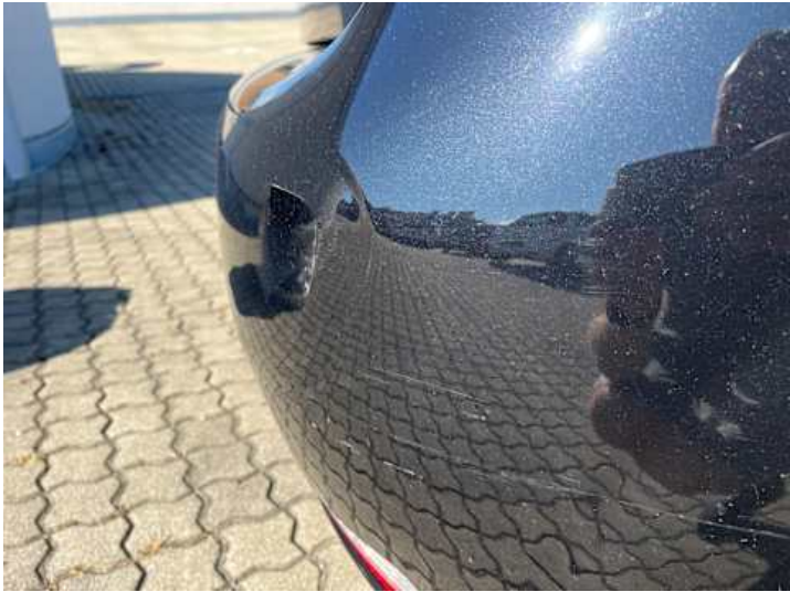
Stoßstange hinten (Kratzer, Lackschaden)
