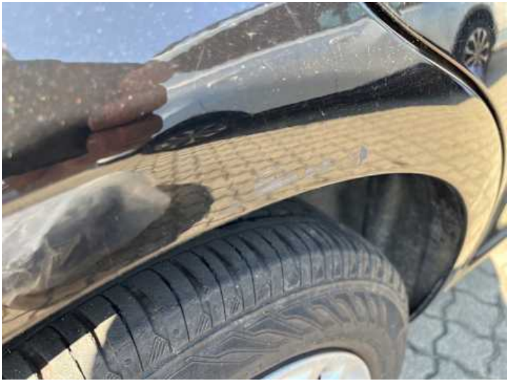
Seitenteil hinten rechts (Lackschaden)
