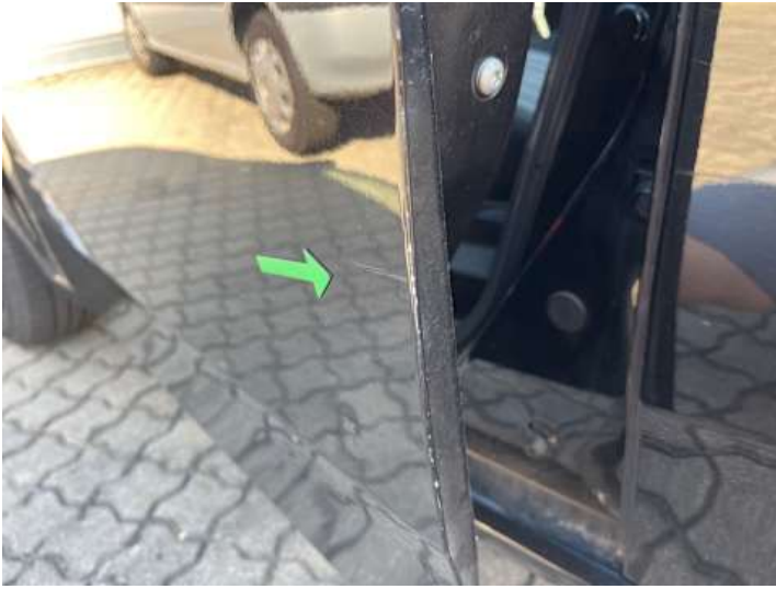
Fahrtür (Kratzer, Lackschaden, Delle)
