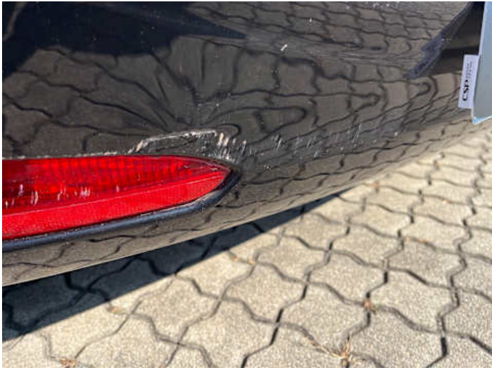
Stoßstange hinten (Kratzer, Lackschaden)
