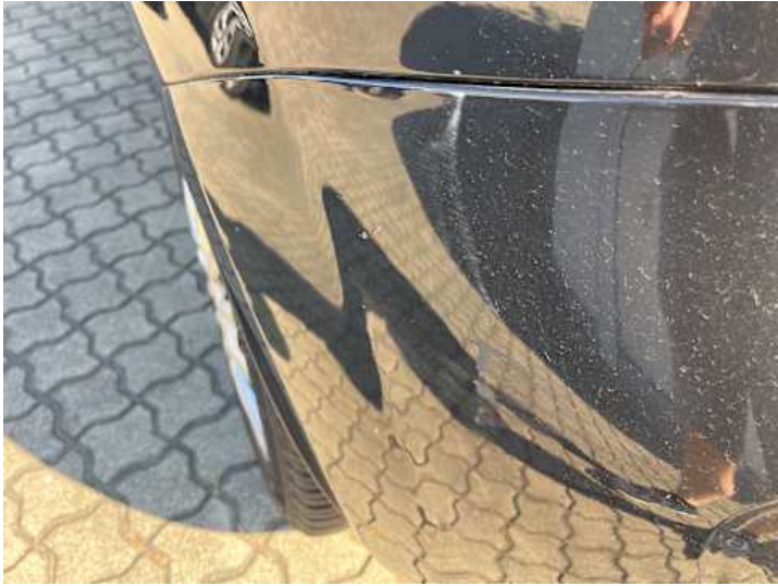
Stoßstange hinten (Kratzer, Lackschaden)
