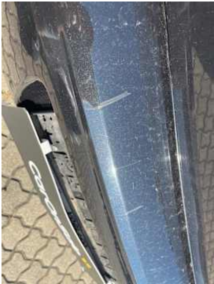
Stoßstange hinten (Kratzer, Lackschaden)
