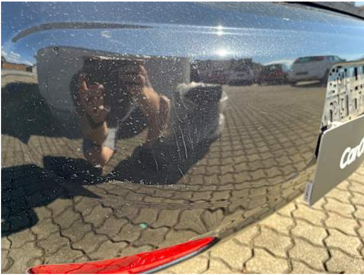
Stoßstange hinten (Kratzer, Lackschaden)
