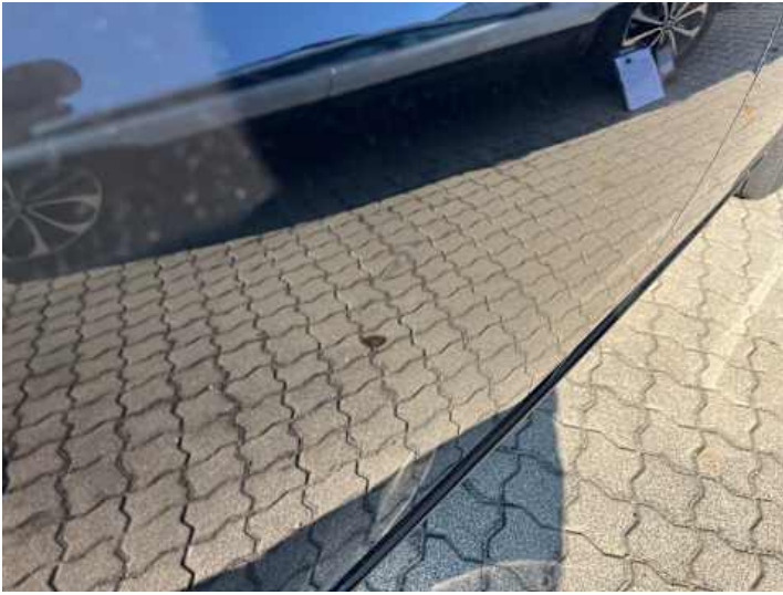
Türe hinten rechts (Kratzer, Lackschaden, Delle)
