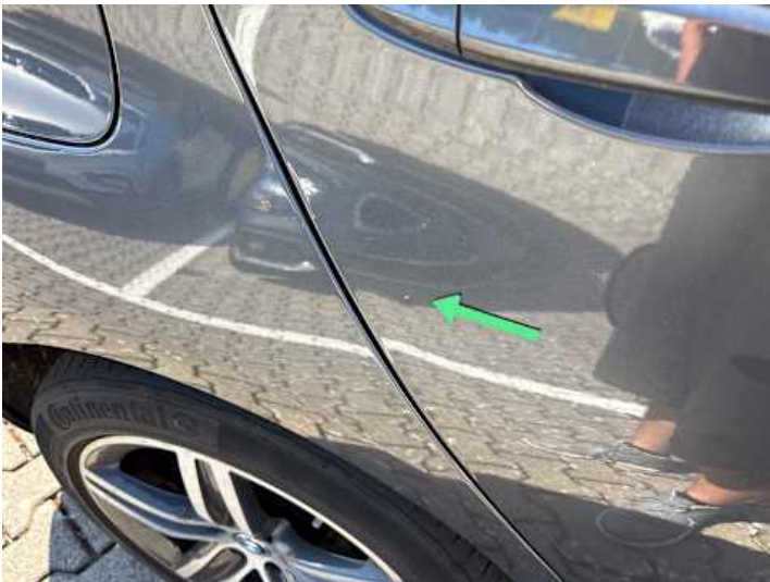
Türe hinten rechts (Delle, Kratzer)
