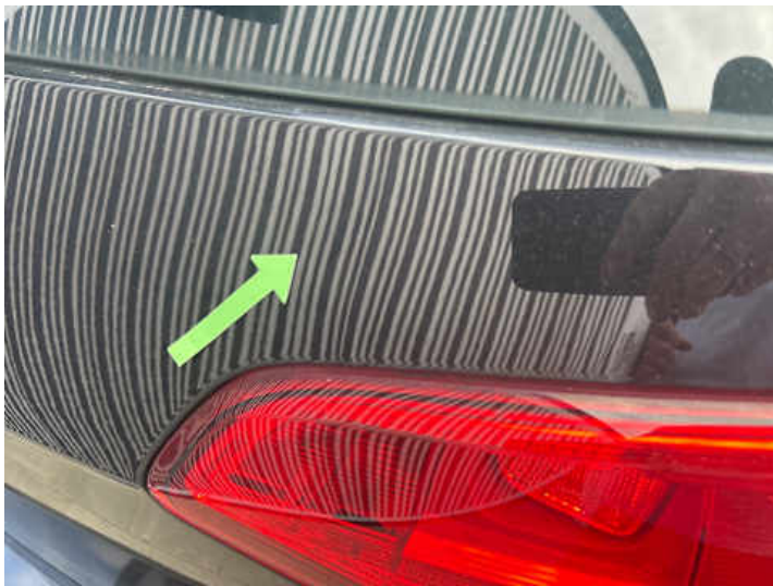
Heckklappe (Delle, Verformung)
