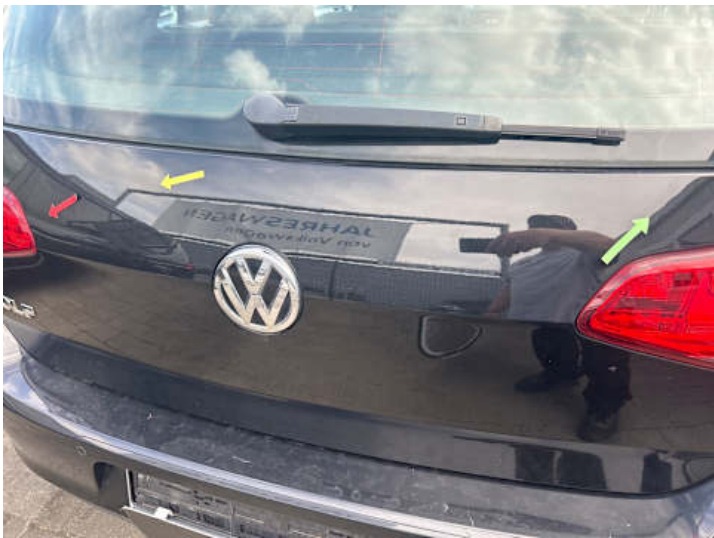
Heckklappe (Delle, Verformung)
