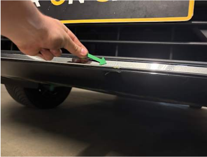
Stoßstange vorne (Kratzer, Lackschaden)
