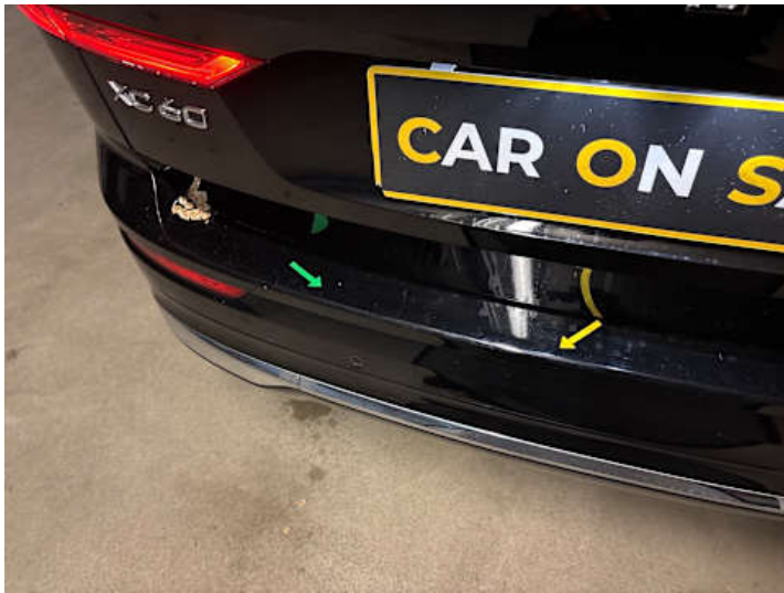
Stoßstange hinten (Kratzer, Lackschaden)
