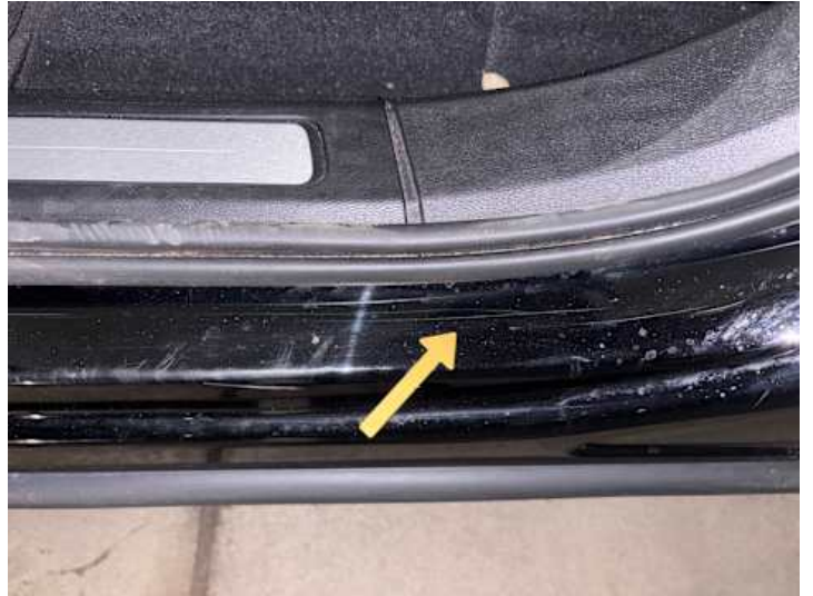
Schweller links (Kratzer)
