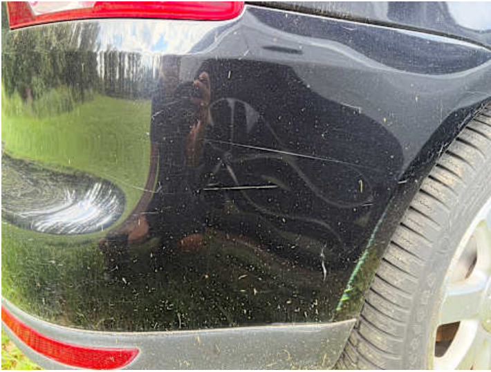
Stoßstange hinten (Lackschaden)
