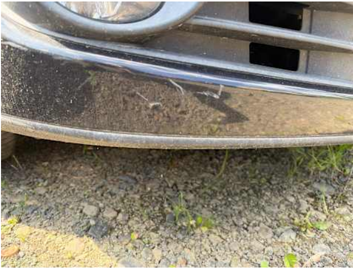
Stoßstange vorne (Lackschaden)
