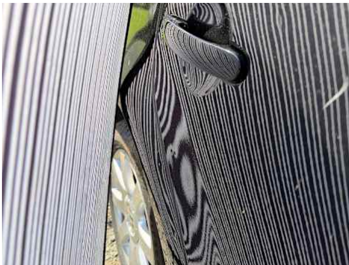
Seitenteil hinten rechts (Delle)
