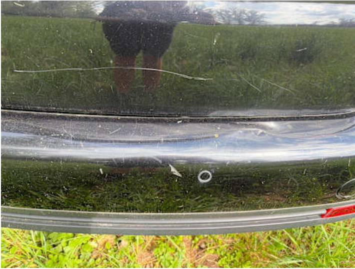
Stoßstange hinten (Lackschaden)
