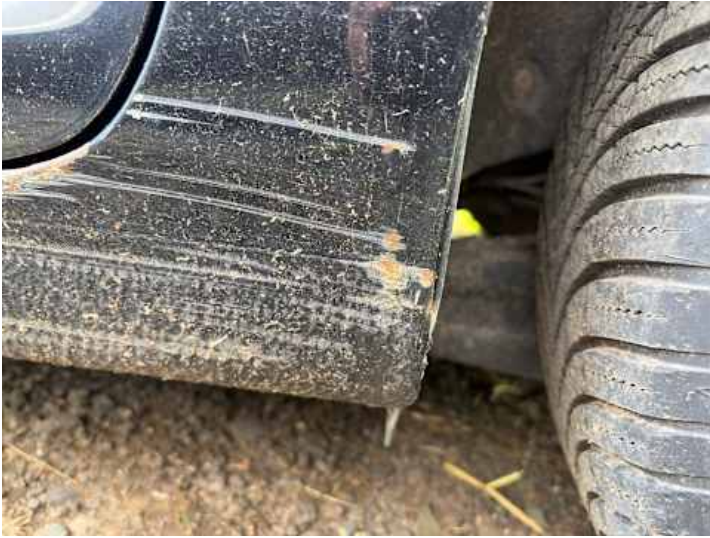
Seitenteil hinten links (Rost)
