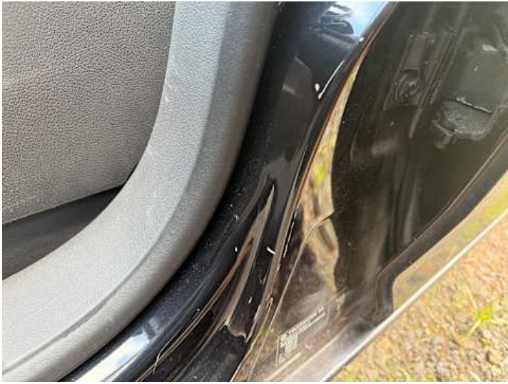
Schweller links (Kratzer)
