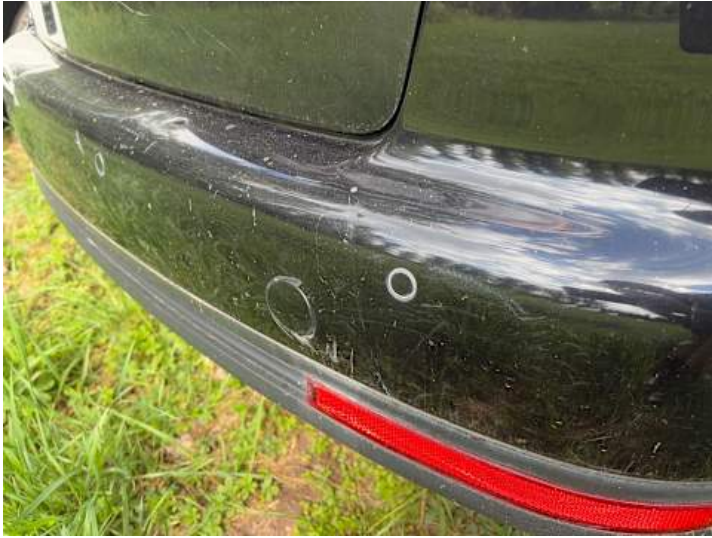
Stoßstange hinten (Lackschaden)
