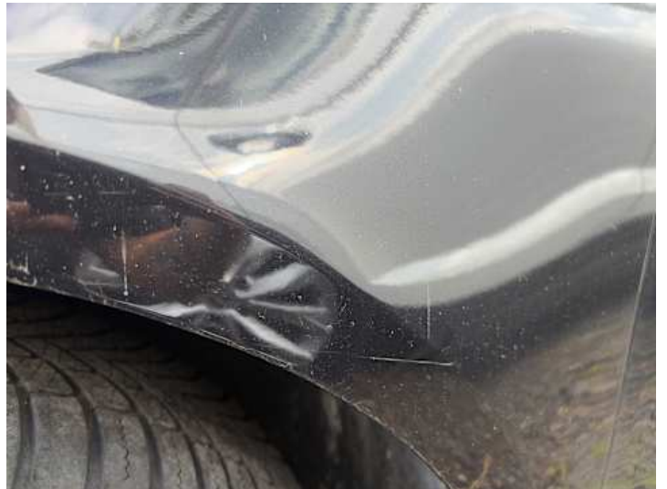
Kotflügel vorne links (Kratzer)
