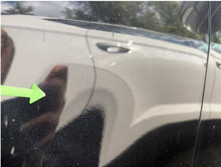
Kotflügel vorne links (Kratzer)
