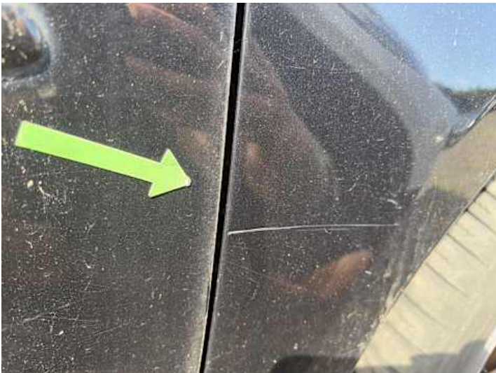
Kotflügel vorne rechts (Kratzer)
