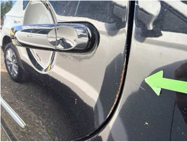
Türe hinten links (Rost)
