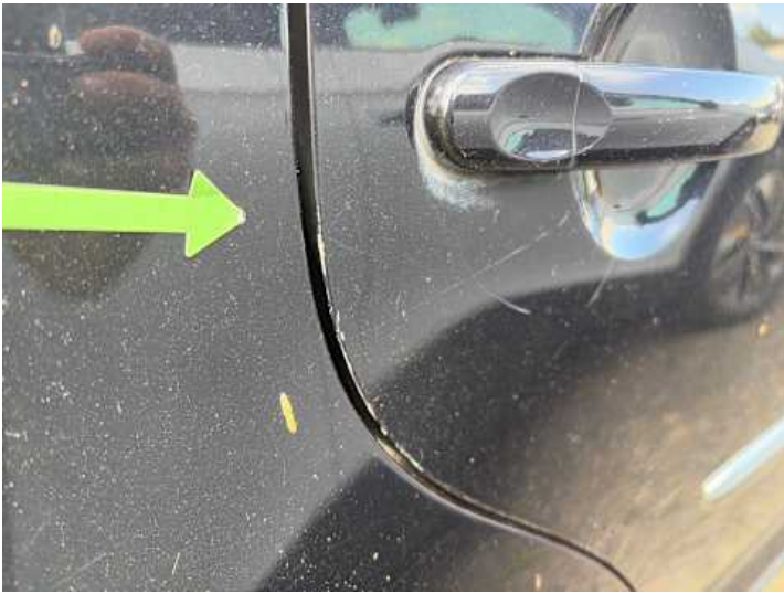
Türe hinten rechts (Lackschaden)
