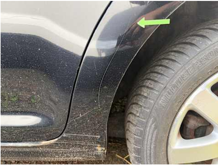
Seitenteil hinten links (Kratzer)
